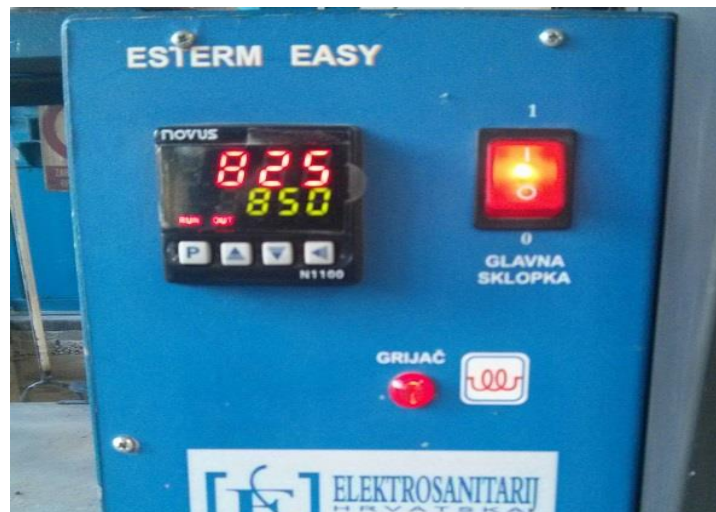
Slika 65. Namještanje temperature taljenja
