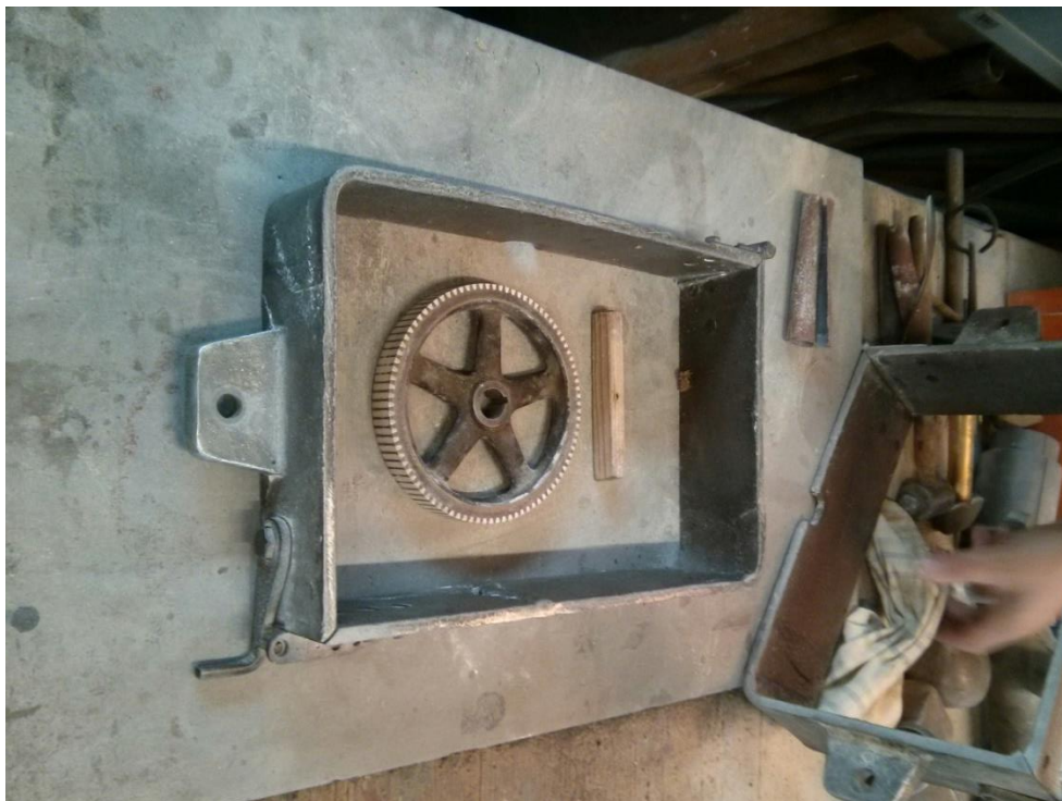
Slika 55. Pozicioniranje modela u donji dio kalupa
