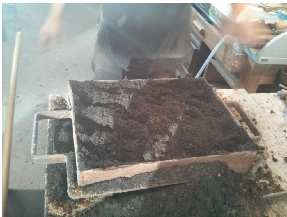
Slika 57. Nasipavanje dopunskim pijeskom
