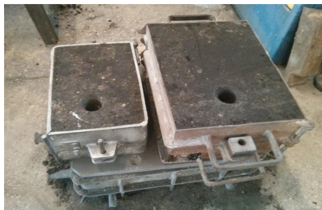
Slika 64. Kalupi spremni za lijevanje
