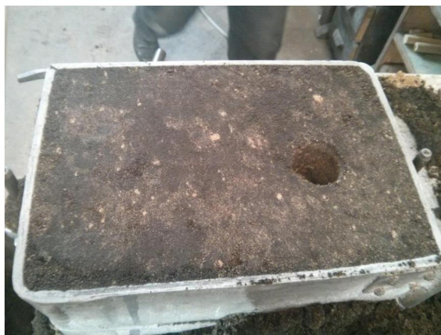
Slika 62. Prikaz otvora za ulijevanje litine
