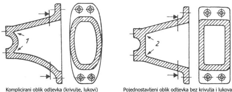
Slika 25. Pojednostavljenje modela [7]
