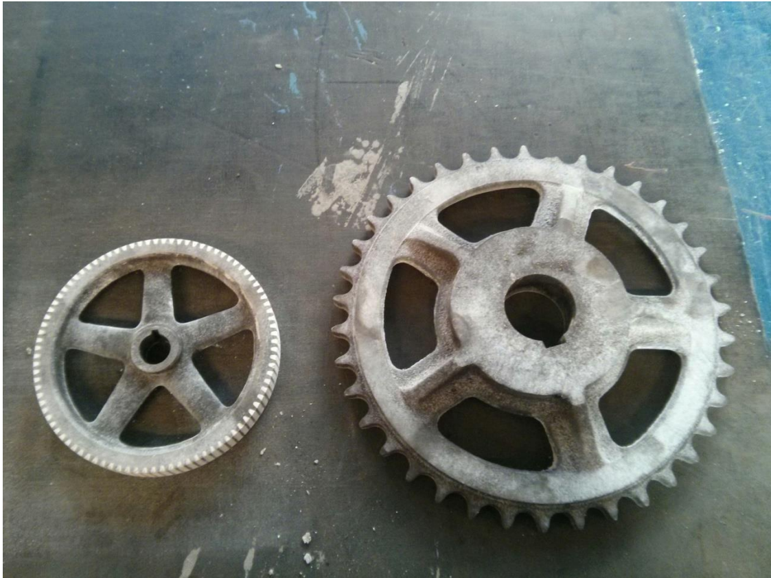
Slika 54. Modeli zupčanika i lančanika korišteni za lijevanje
