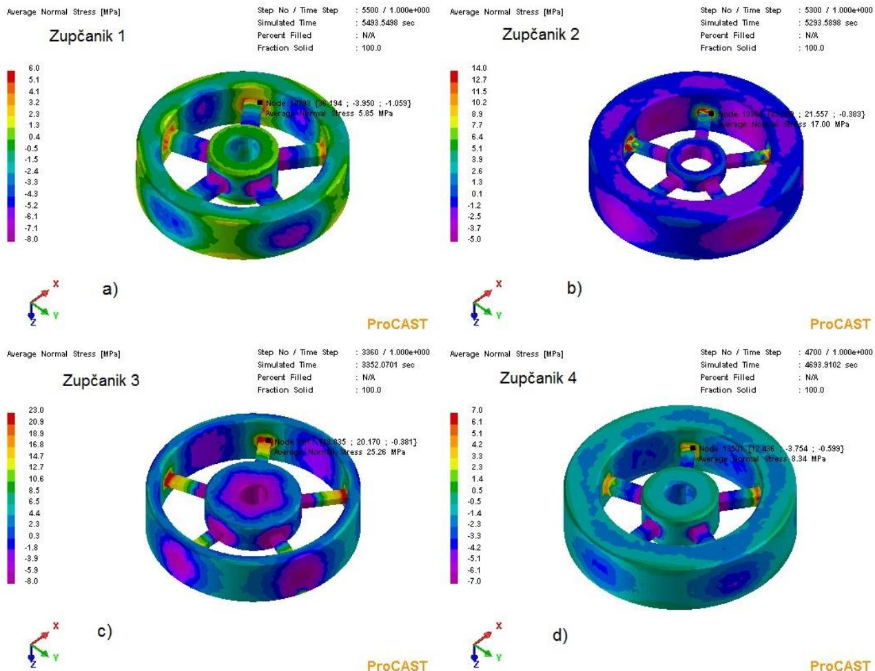
Slika 53. Prikaz naprezanja unutar odljevaka uslijed skrućivanja
