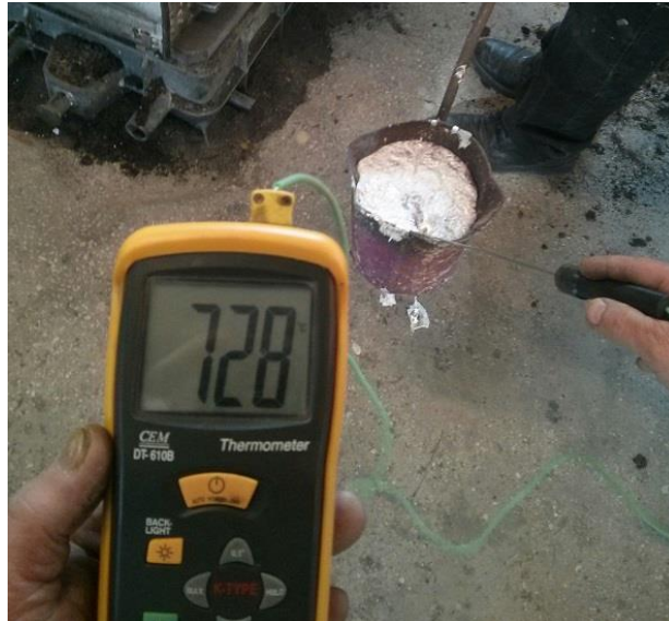
Slika 69. Mjerenje temperature taljevine neposredno prije ulijevanja
