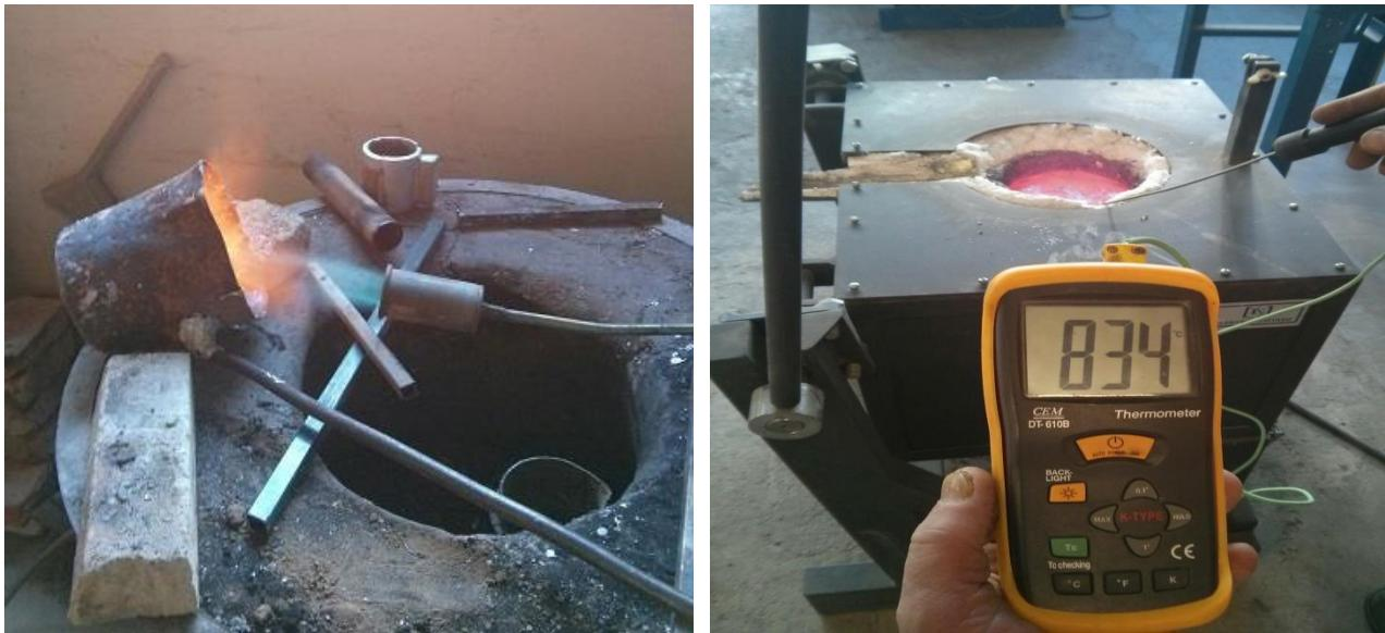
Slika 67. Predgrijavanje lonca (lijevo) i mjerjenje temperature litine unutar peći (desno)
