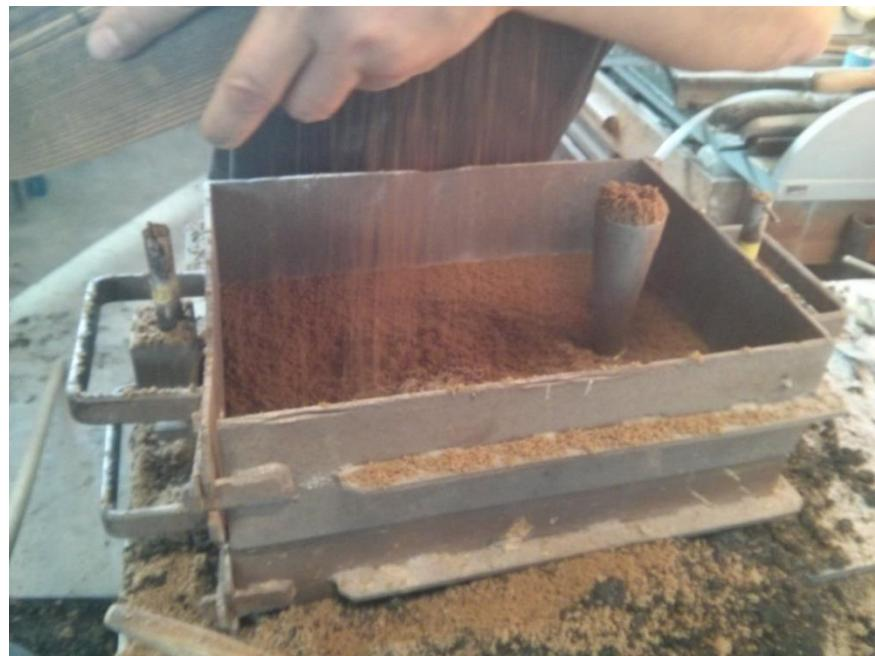
Slika 61. Pozicioniranje spusta u gornji dio kalupa
