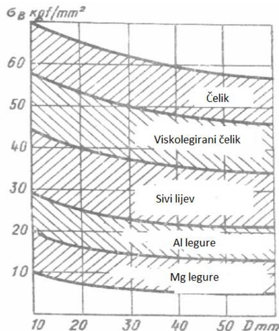
Slika 8. Omjer između čvrstoće i promjera (debljine) stijenke [8]
