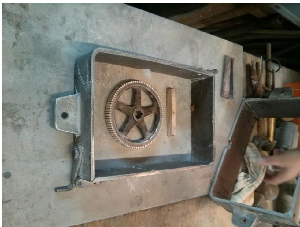
Slika 55. Pozicioniranje modela u donji dio kalupa
