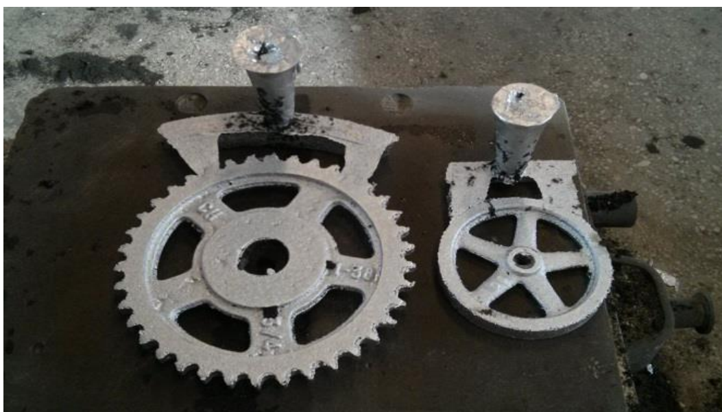
Slika 72. Prikaz odljevaka s uljevnim sustavom
