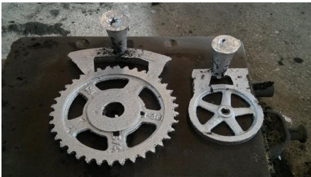
Slika 72. Prikaz odljevaka s uljevnim sustavom
