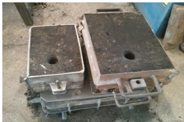
Slika 64. Kalupi spremni za lijevanje
