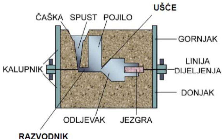
Slika 4. Dijelovi jednokratnog kalupa za postupak sa svježom kalupnom mješavinom [1]
