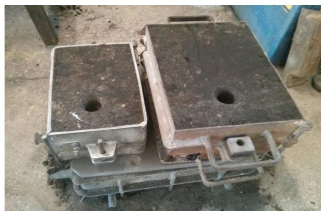
Slika 64. Kalupi spremni za lijevanje
