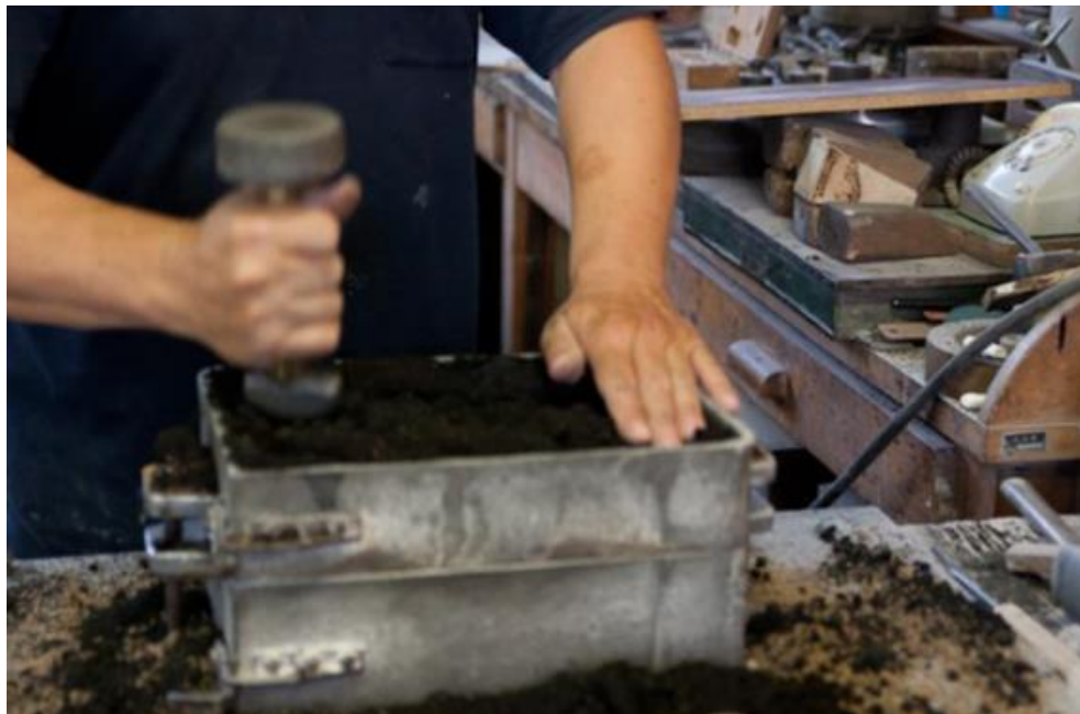
Slika 58. Sabijanje kalupne mješavine
