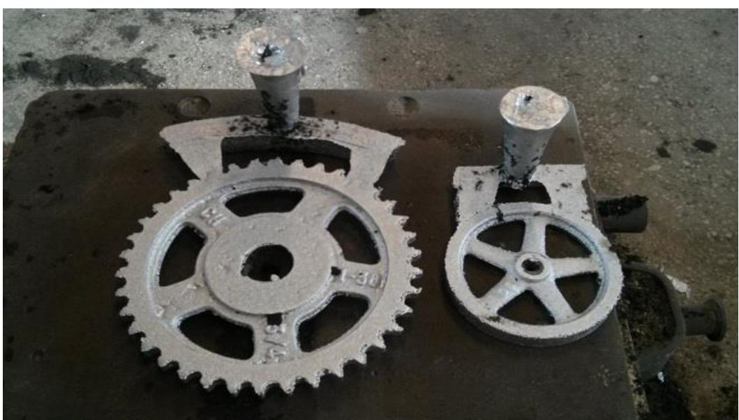
Slika 72. Prikaz odljevaka s uljevnim sustavom
