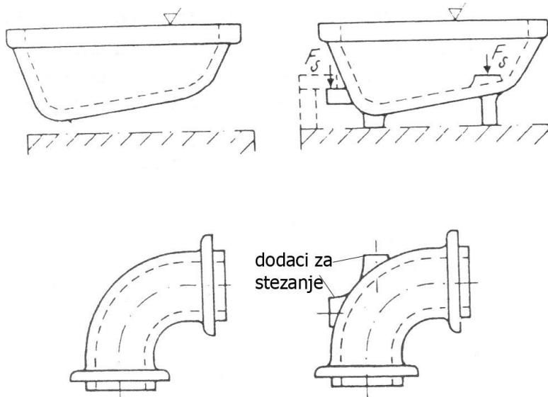
Slika 34. Dodaci za stezanje pri strojnoj obradi [7]
