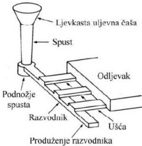
Slika 7. Dijelovi uljevnog sustava [6]
