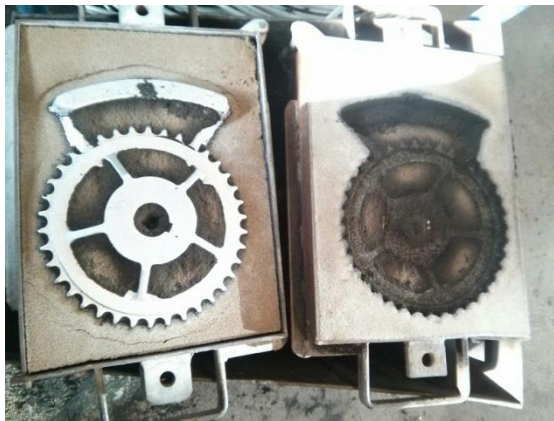
Slika 71. Otvaranje i rastresanje kalupa
