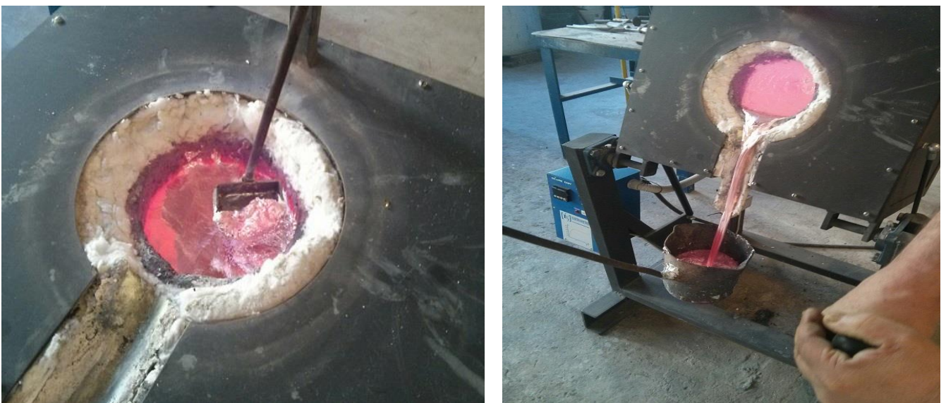
Slika 68. Uklanjanje nečistoća (lijevo) i ulijevanje litine u lonac za transport (desno)
