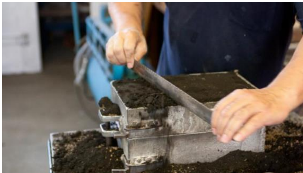
Slika 59. Poravnavanje donjeg dijela površine kalupa
