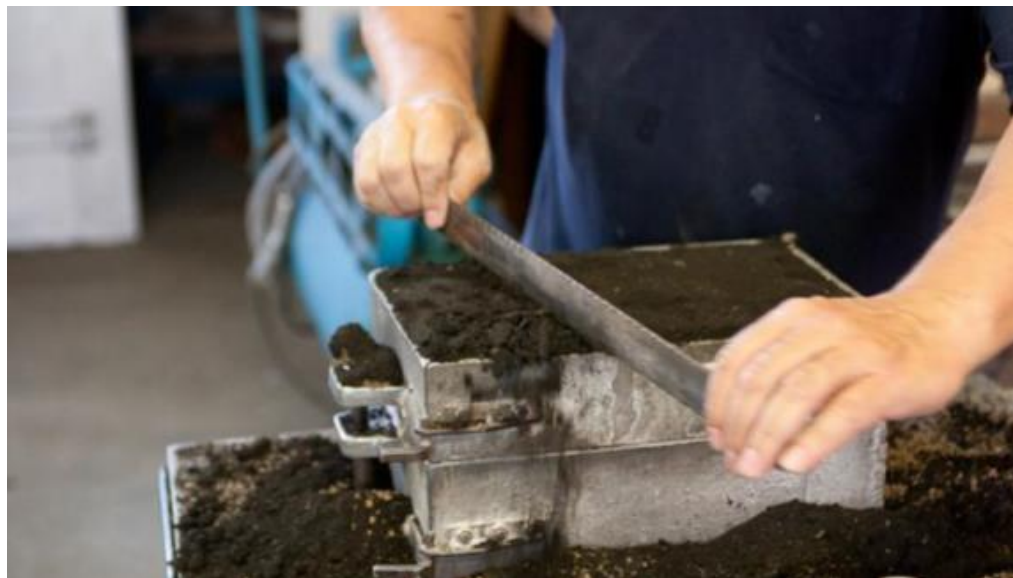
Slika 59. Poravnavanje donjeg dijela površine kalupa
