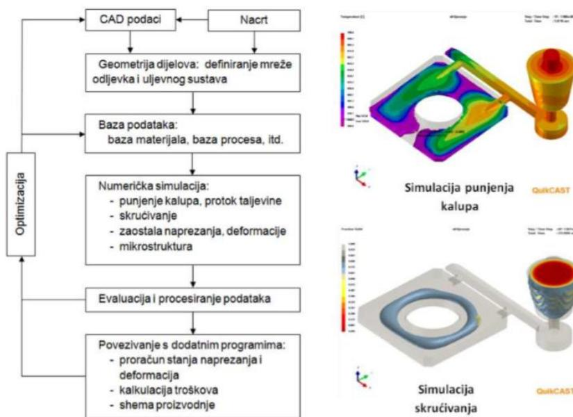
Slika 15. Prikaz simulacije procesa lijevanja programom QuickCast [1,13]
