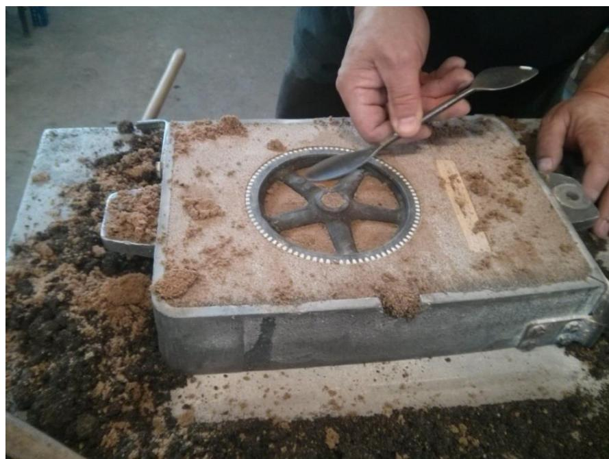
Slika 60. Prikaz modela zupčanika i lančanika unutar kalupa i čišćenje viška pjeska lancetom
