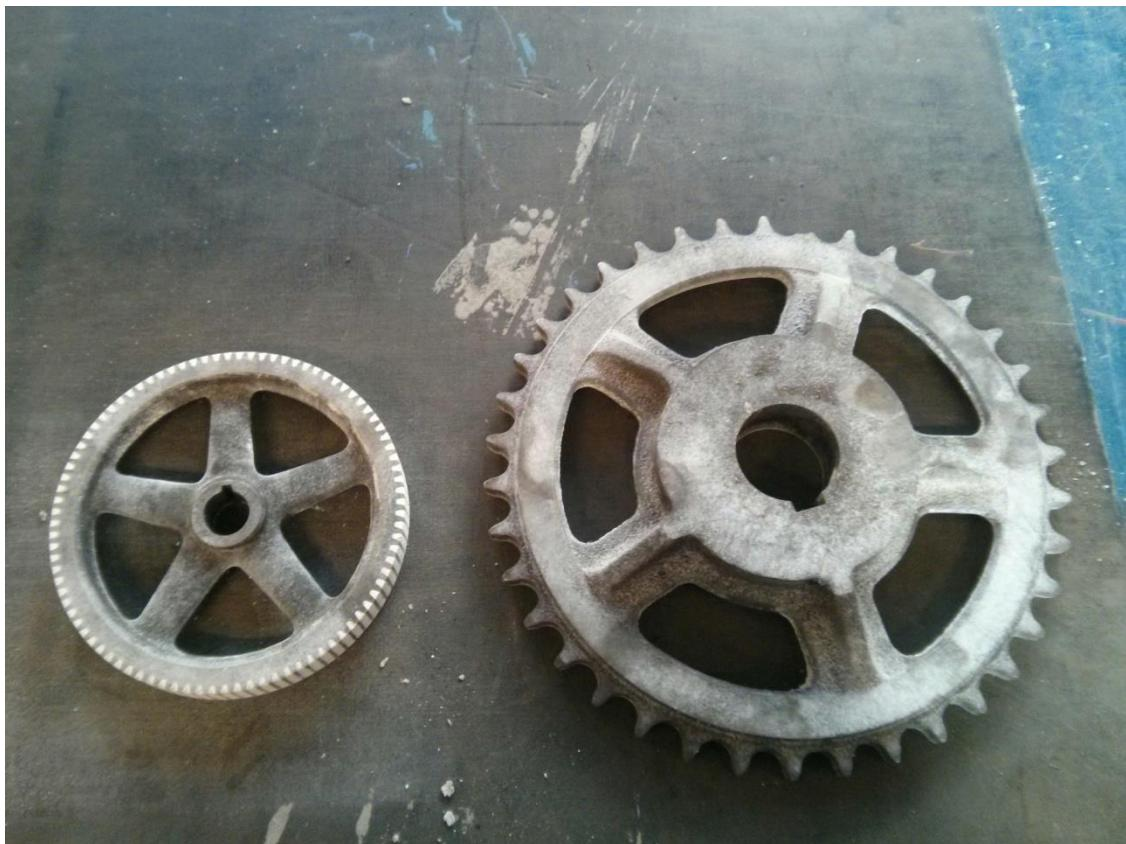
Slika 54. Modeli zupčanika i lančanika korišteni za lijevanje
