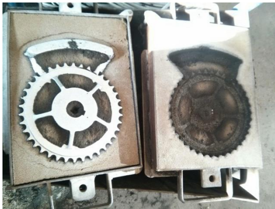
Slika 71. Otvaranje i rastresanje kalupa
