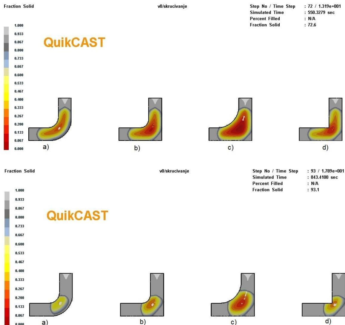
Slika 39. Skrućivanje kutnika prema toplom čvorištu u poprečnom presjeku
