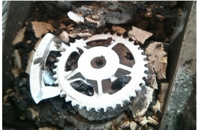
Slika 71. Otvaranje i rastresanje kalupa
