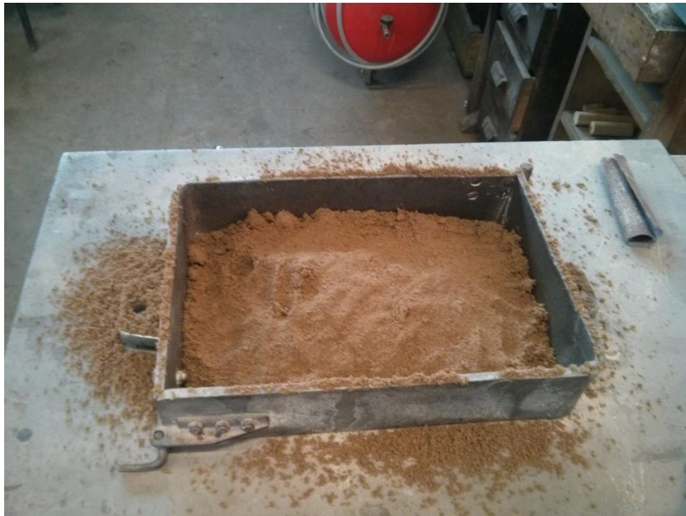
Slika 56. Posipavanje modelnim pijeskom
