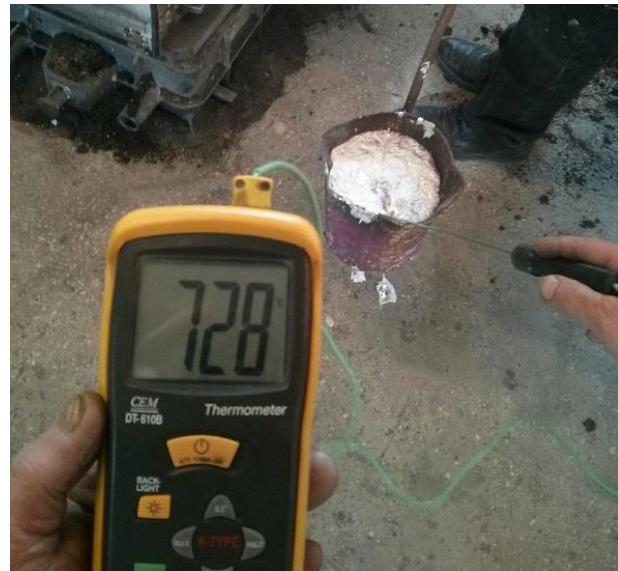
Slika 69. Mjerenje temperature taljevine neposredno prije ulijevanja
