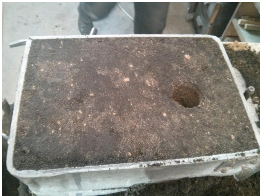
Slika 62. Prikaz otvora za ulijevanje litine
