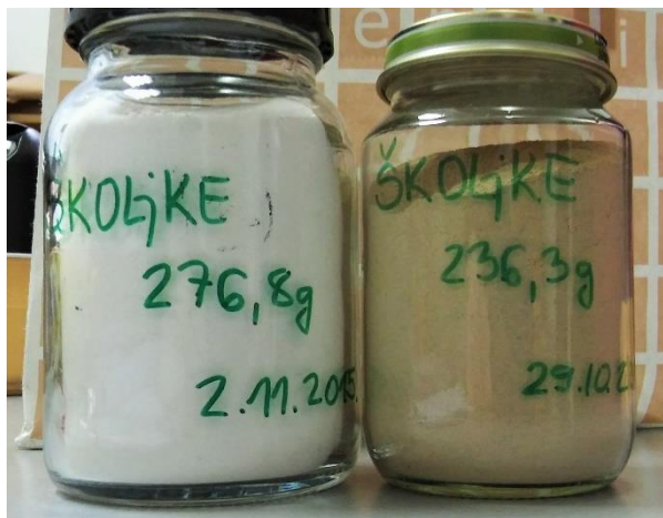
Slika 10. Prah školjaka nakon usitnjavanja u mlinu: Codakia orbicularis lijevo i Cerastoderma edula desno)
