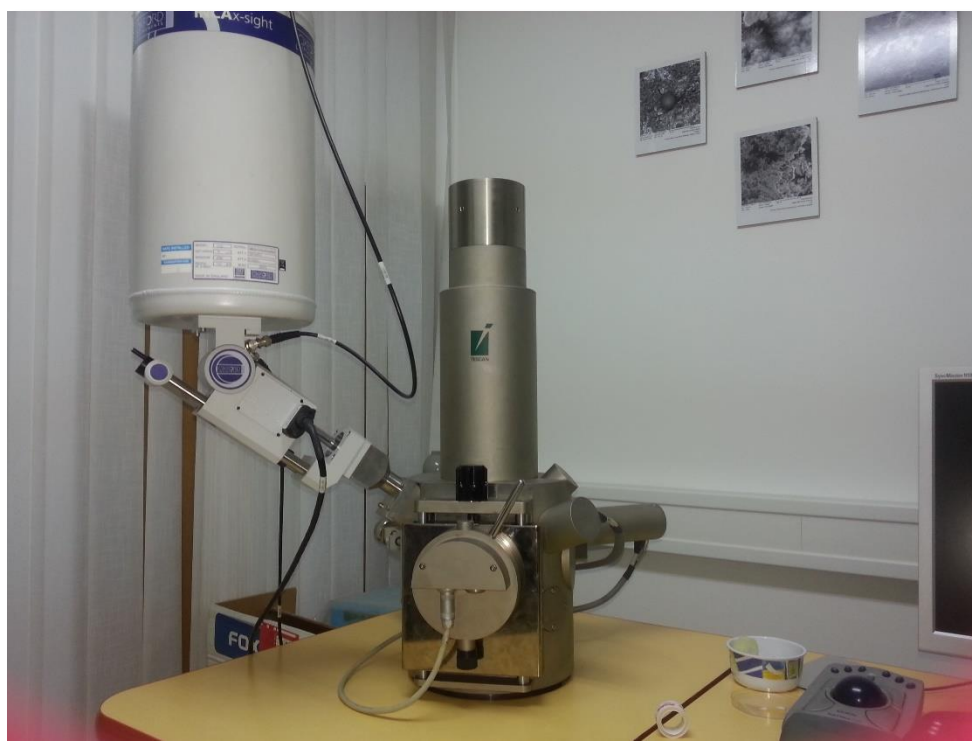
Slika 23. Skenirajući elektronski mikroskop Tescan Vega 5136mm
