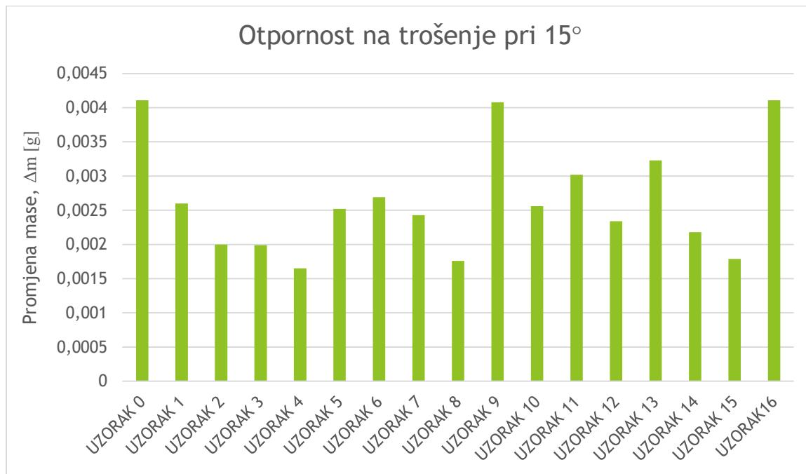
Slika 24. Otpornost na erozijsko trošenje pri  $15^\circ$
