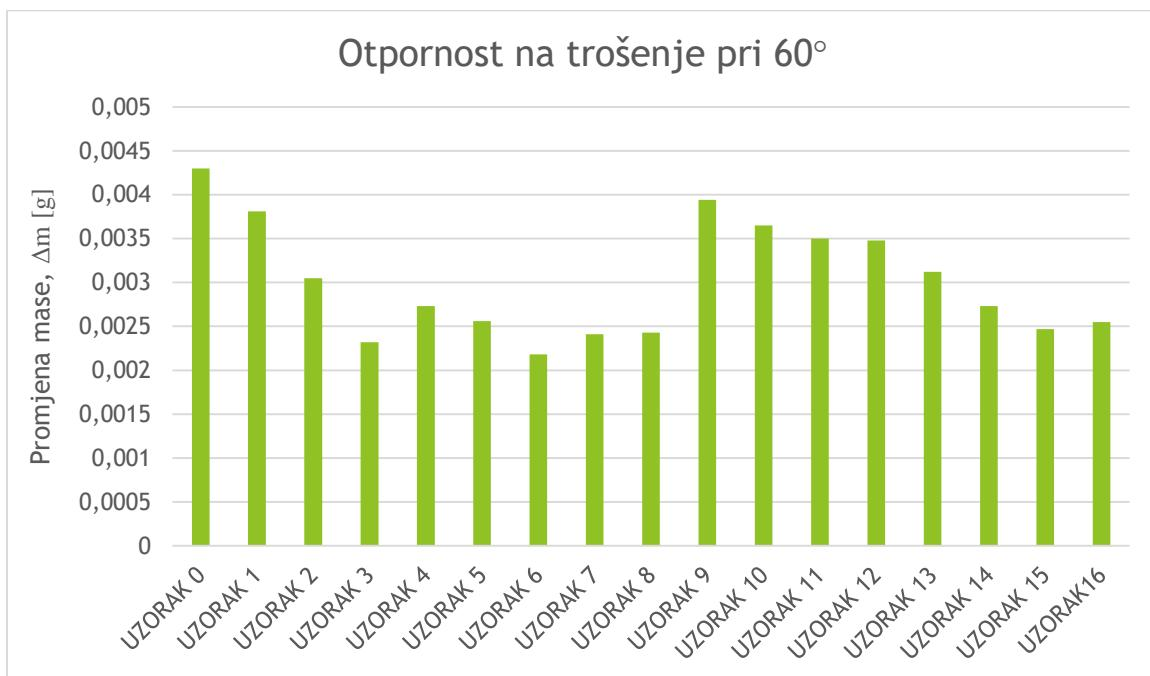
**Slika 26. Otpornost na erozijsko trošenje pri  $60^\circ$**
