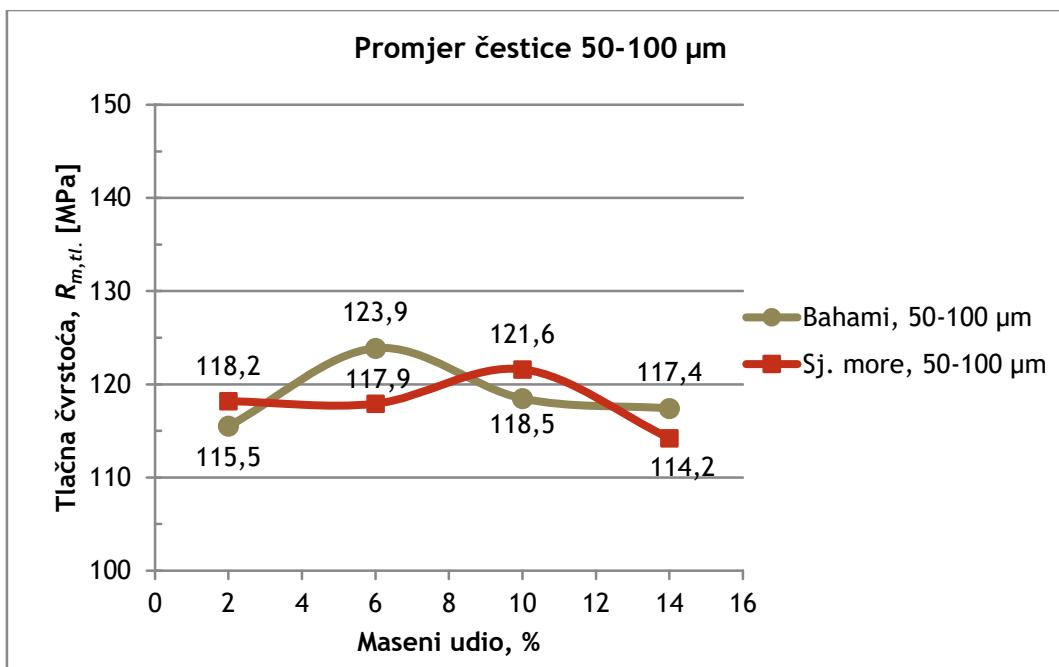
Slika 36. Tlačna čvrstoća uzoraka s promjerom čestice od 50 do 100 Promjer čestice &lt; 50 µm
