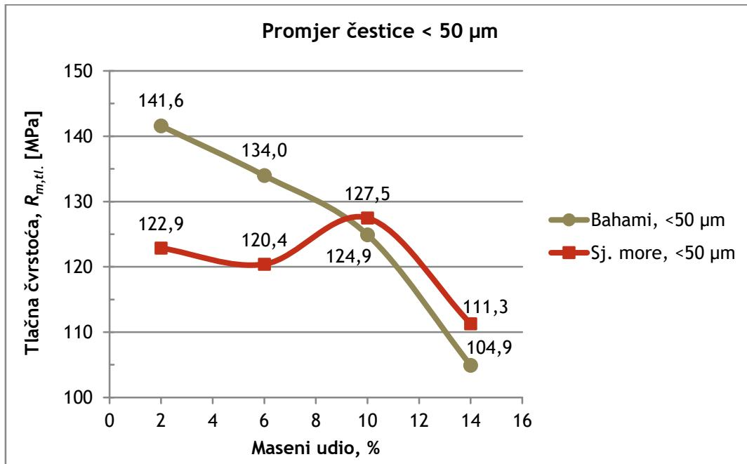
Slika 40. Tlačna čvrstoća uzoraka s promjerom čestice < 50 μm
