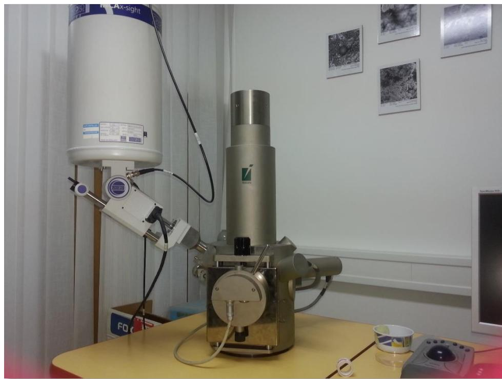
Slika 23. Skenirajući elektronski mikroskop Tescan Vega 5136mm
