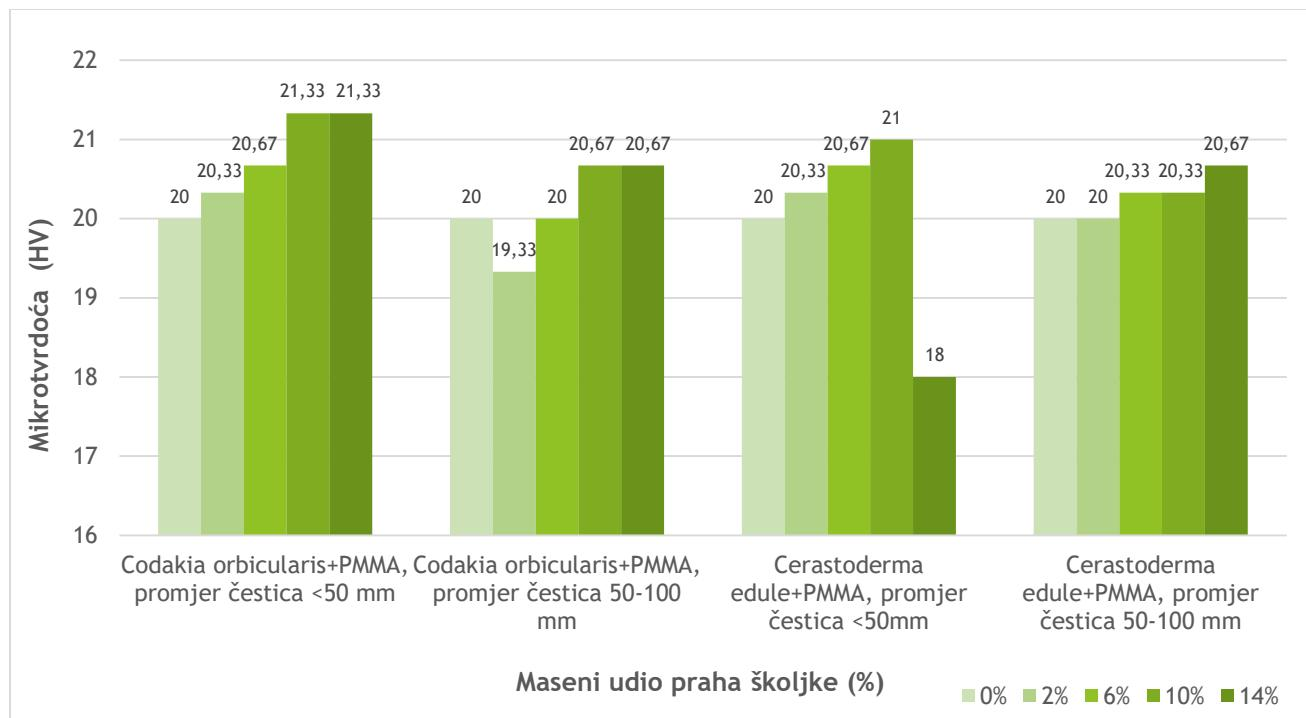
Slika 35. Usoredni dijagramski prikaz tvrdoće ispitnih uzoraka
