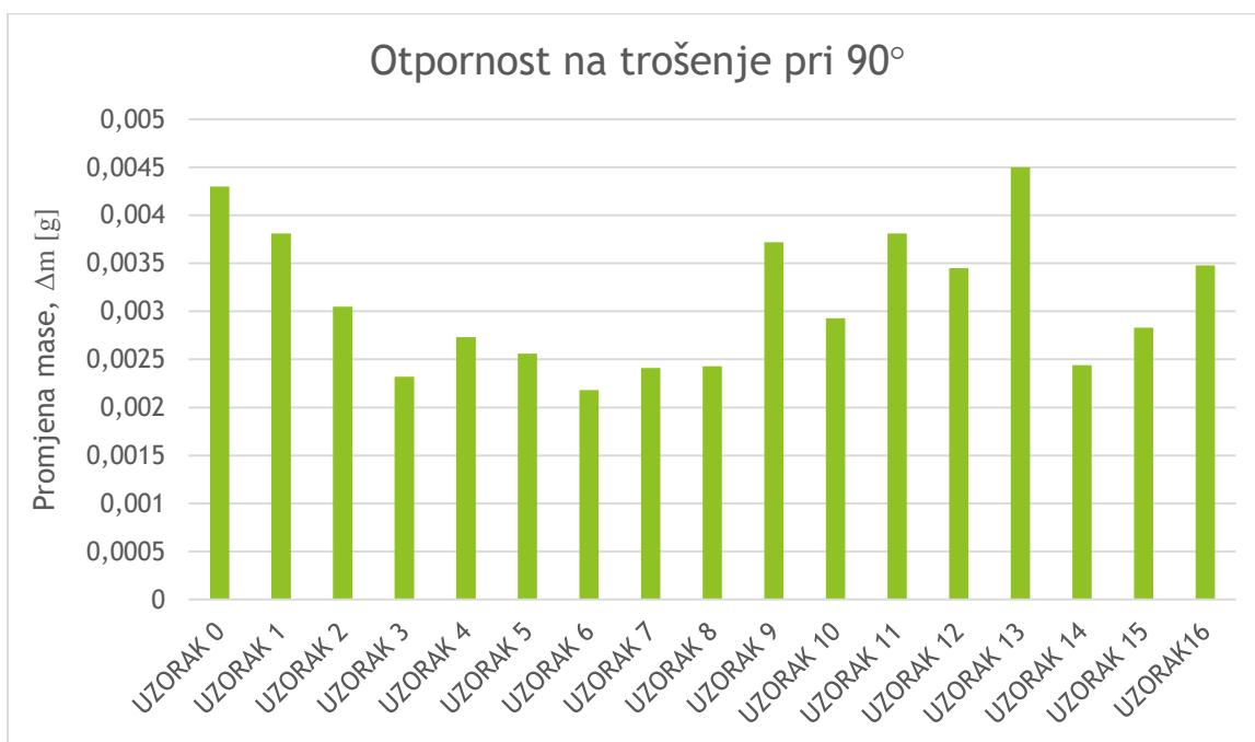
**Slika 27. Otpornost na erozijsko trošenje pri  $90^\circ$**
