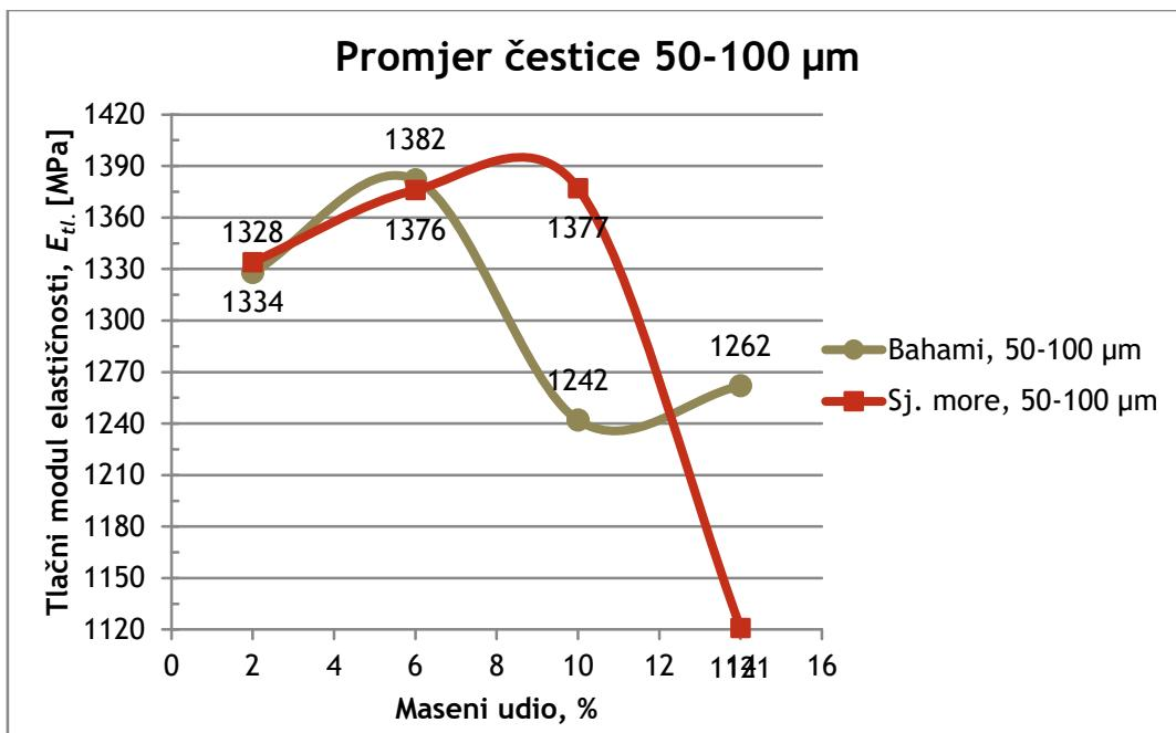
Slika 40. Modul elastičnosti uzorka s promjerom čestice 50-100 µm
