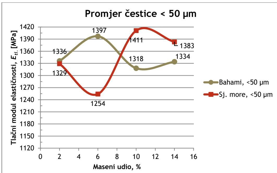
Slika 39. Modul elastičnosti uzorka s promjerom čestice &lt; 50 µm
