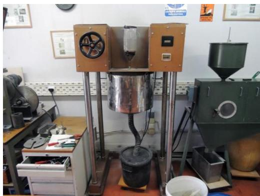
Slika 19. Uređaj za erozijsko trošenje
