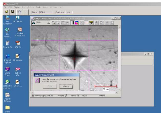
Slika 22. Analiziranje mikrotvrdoće pomoću programa INSTRON ATA
