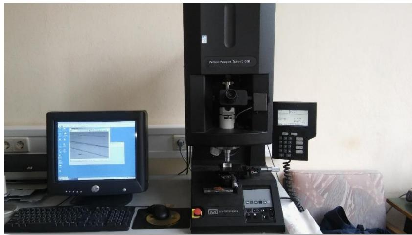
Slika 21. Uredaj za ispitivanje mikrotvrdoće
