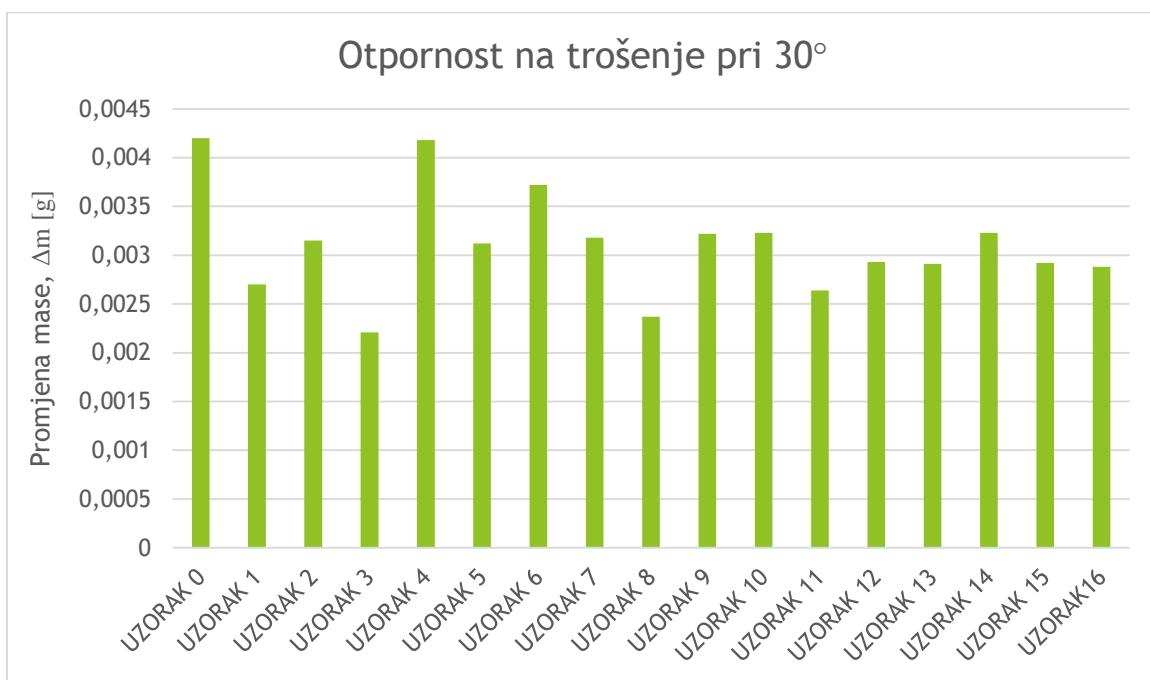
**Slika 25. Otpornost na erozijsko trošenje pri  $30^\circ$**
