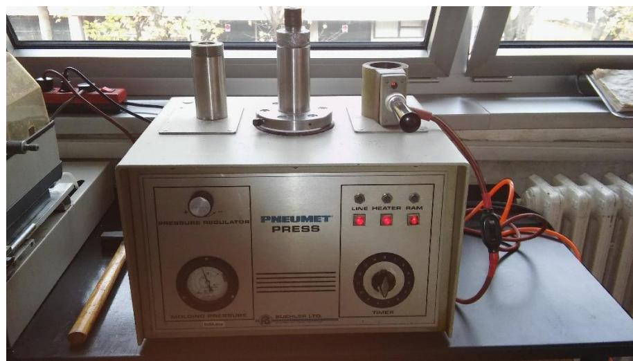
**Slika 16. Pneumet Press preša**
