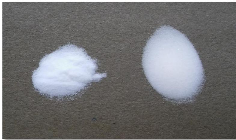
**Slika 15.** Prahovi nakon homogenizacije školjaka i PMMA (*Codakia orbicularis*+PMMA s lijevo, *Cerastoderma edule*+PMMA desno)
