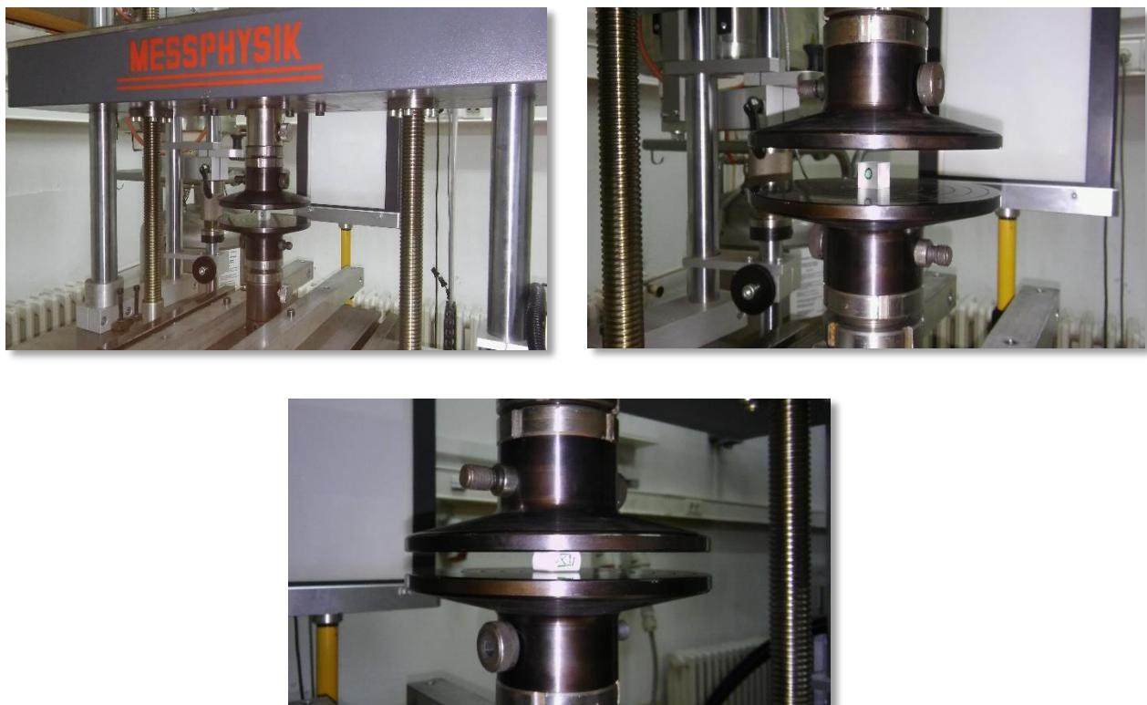
Slika 25. Uredaj za ispitivanje čvrstoće s neopterećenim uzorkom (gore) i opterećenim uzorkom (dolje)
