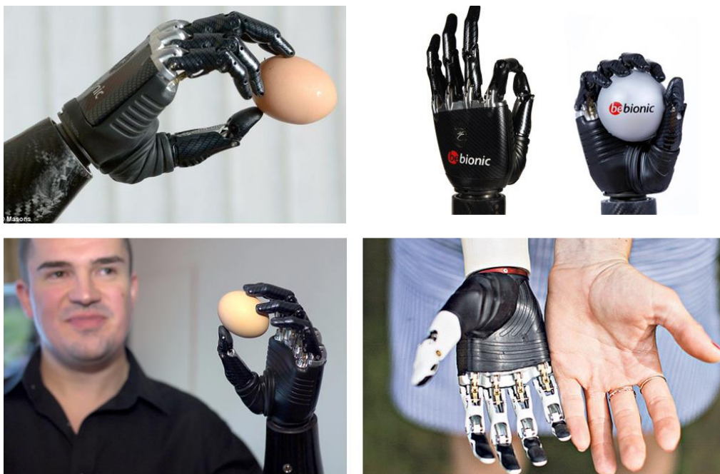
Slika 6 Bebionic proteza za podlakticu [13]
