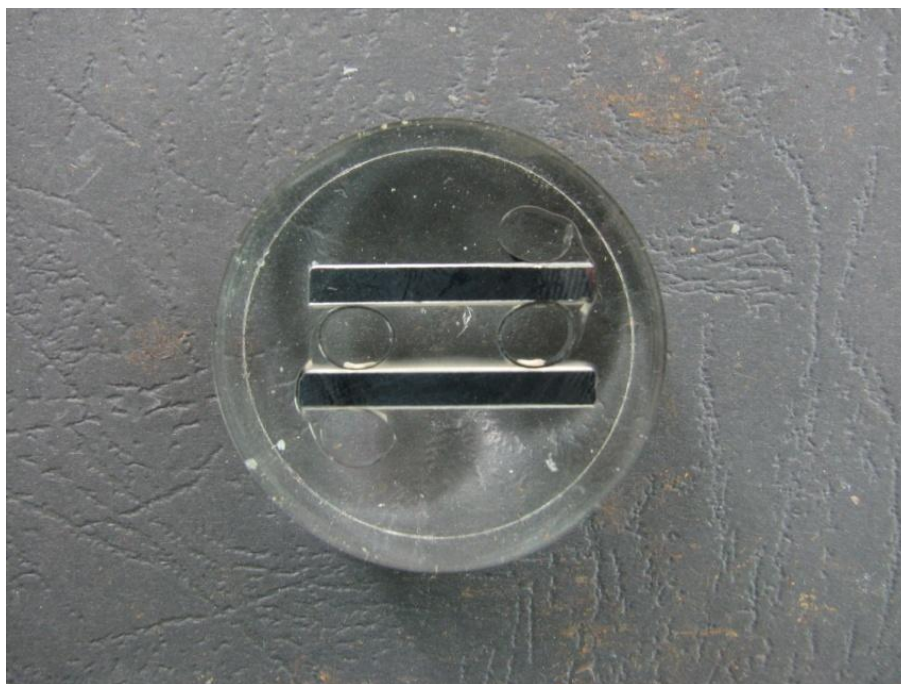
Slika 47. Pripremljeni uzorci sustava premaza A i B za mikrostrukturna ispitivanja
