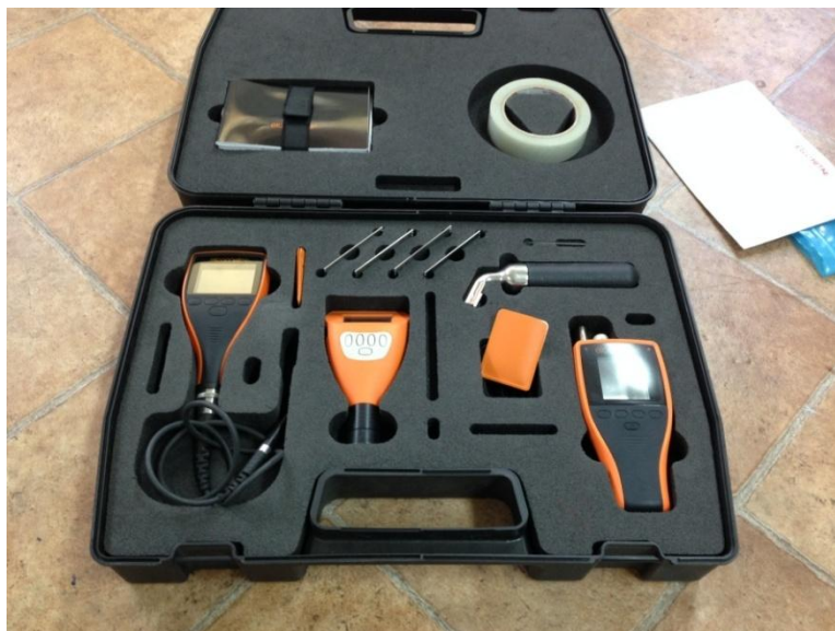
Slika 26. Elcometer 456, uređaj za određivanje debljine suhog filma premaza
