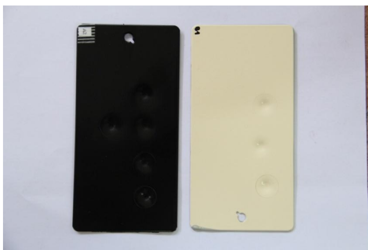
Slika 33. Uzorci A2 i B1 podvrgnuti ispitivanju otpornosti na udar
