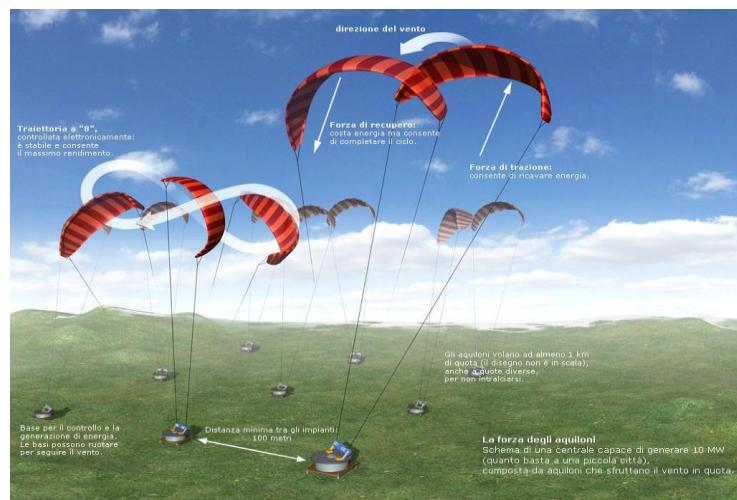
**Slika 20. Koncept visinskih zračnih agregata, Kite Gen [19]**
