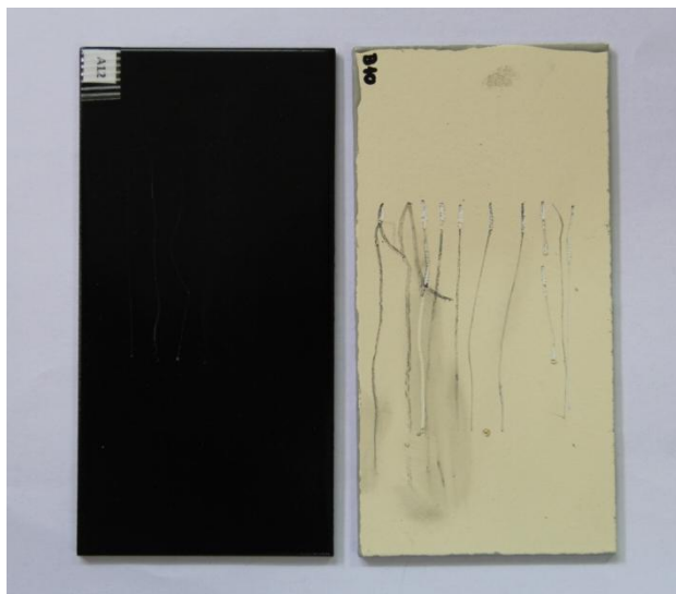
Slika 31. Provedeno ispitivanje tvrdoće olovkama na uzorcima A12 i B10
