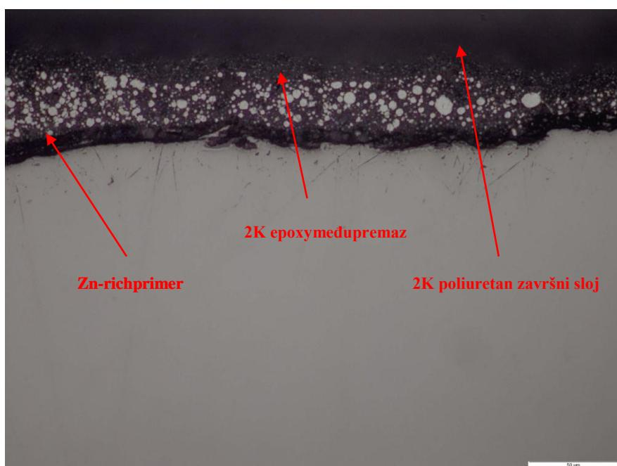
Slika 49. Mikrostruktura sustava premaza B, povećanje 500 x
