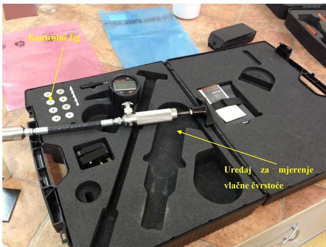
Slika 41. Oprema za provođenje pulloff testa, Elcometer 108
