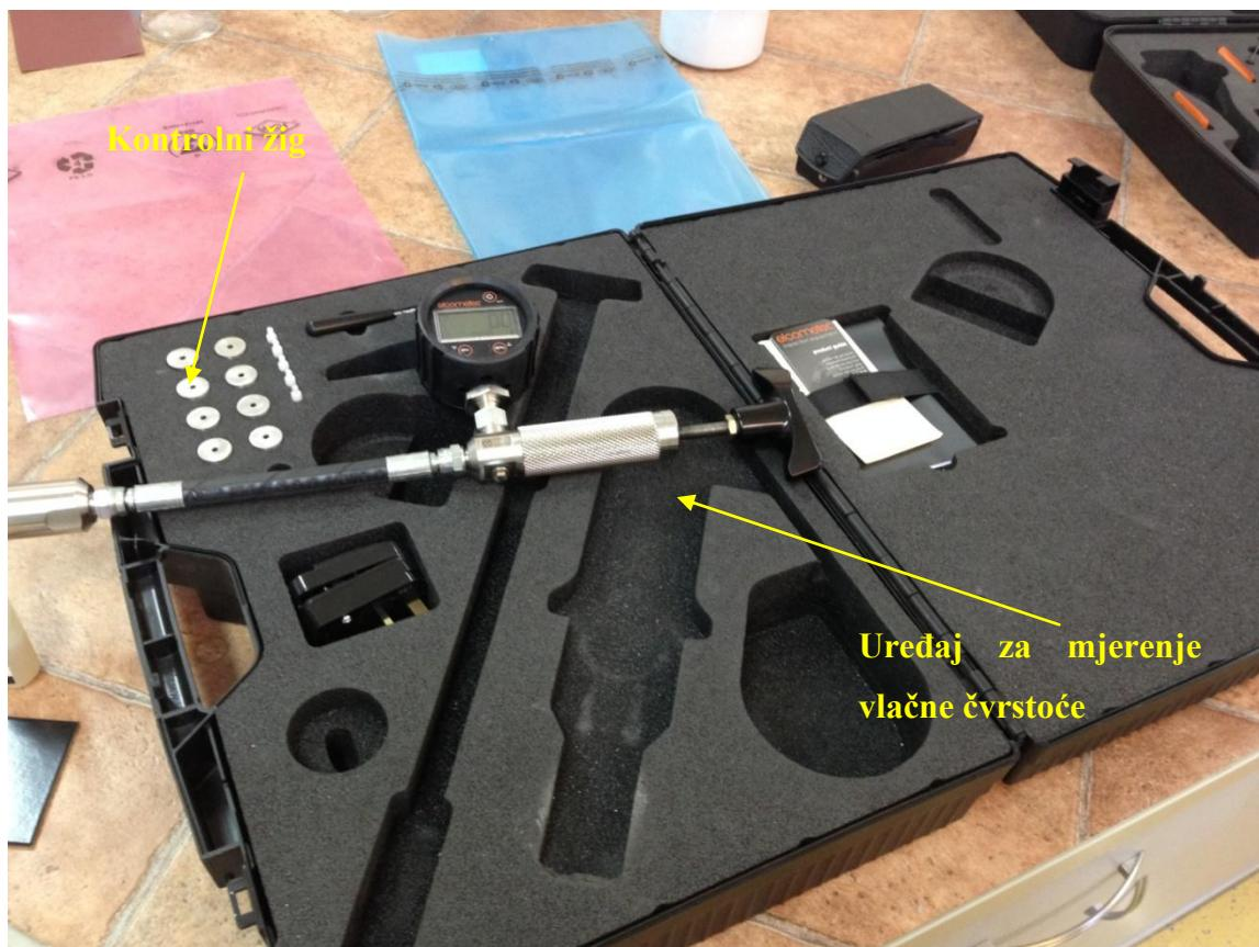
Slika 41. Oprema za provođenje pulloff testa, Elcometer 108
