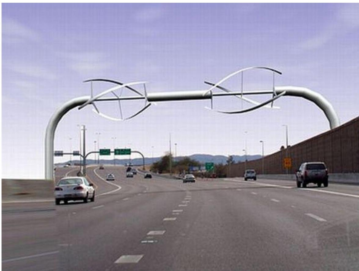
Slika 15. Horizontalna izvedba Darrieus-ove vjetroturbine [14]
