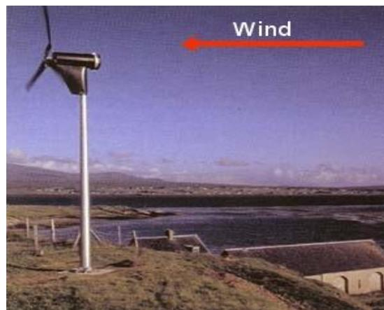
Slika 9. Downwind rotor [7]
