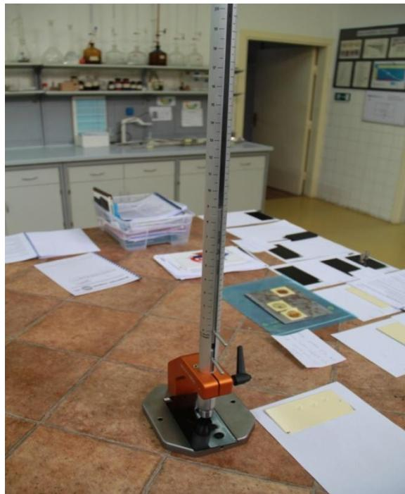
**Slika 32. Utg za utvrđivanje otpornosti premaza na udar s postavljenim uzorkom**
