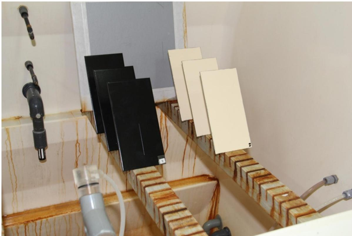
Slika 37. Uzorci sustava A i B prije ispitivanja u slanoj komori
