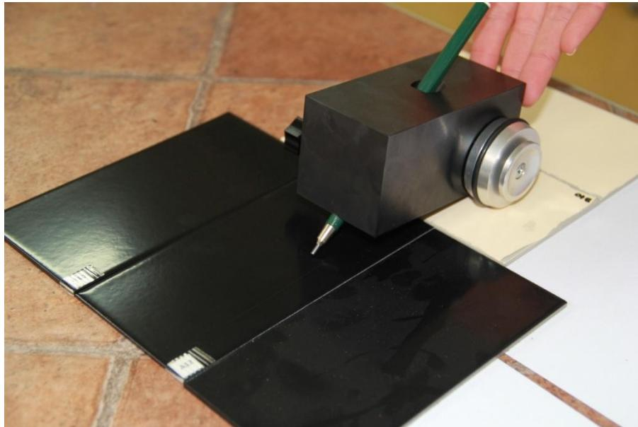
Slika 29. Postupak određivanja tvrdoće premaza metodom olovaka
