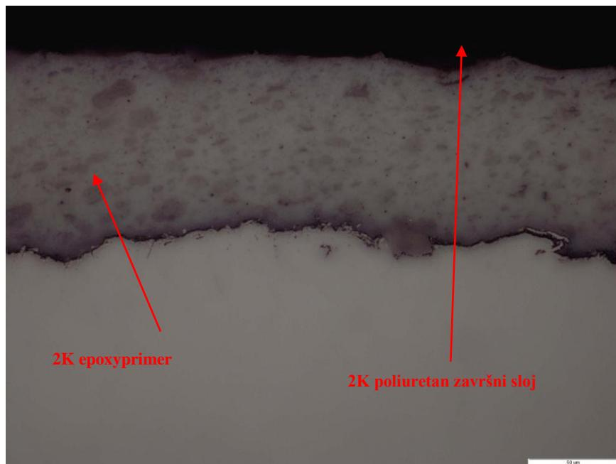
Slika 48. Mikrostruktura sustava premaza A, povećanje 500 x
