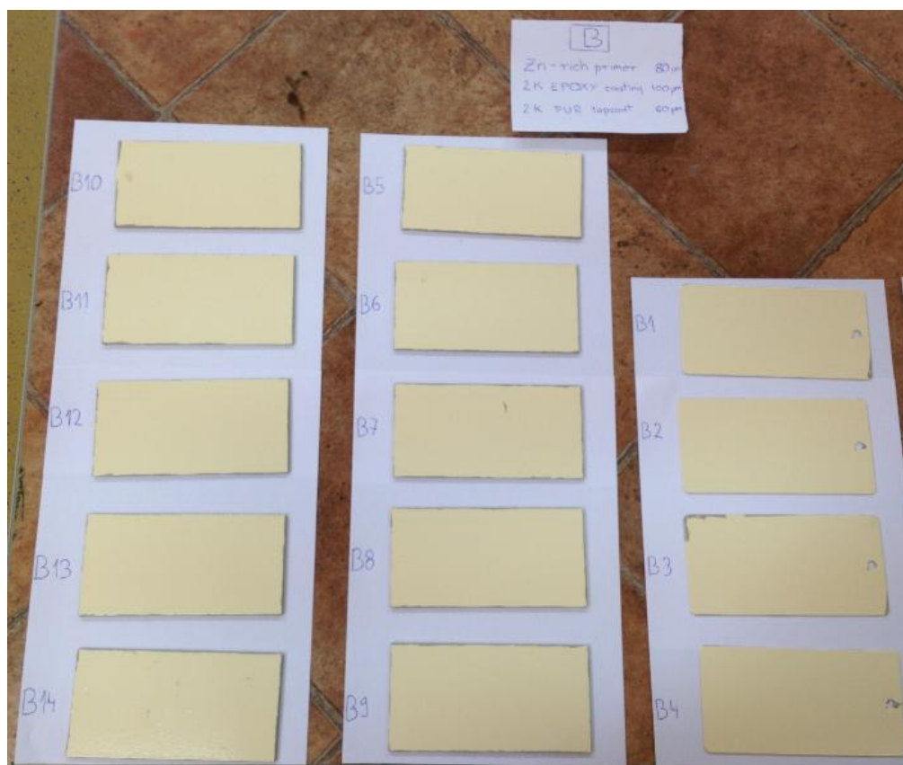
Slika 25. Uzorci sustava premaza B, na bazi otapala
