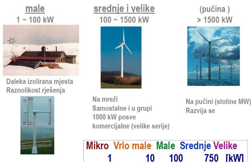
Slika 16. Podjela vjetroelektrana prema instaliranoj snazi [2]
