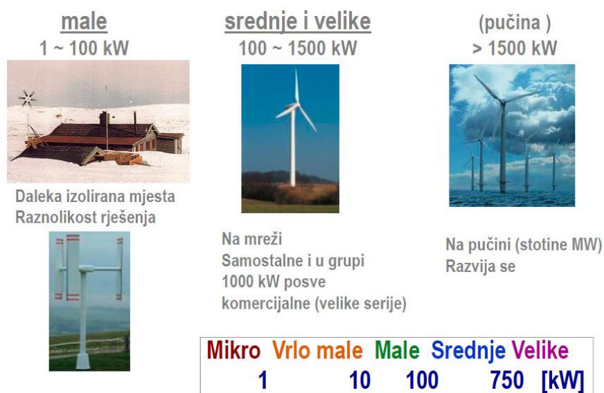
Slika 16. Podjela vjetroelektrana prema instaliranoj snazi [2]
