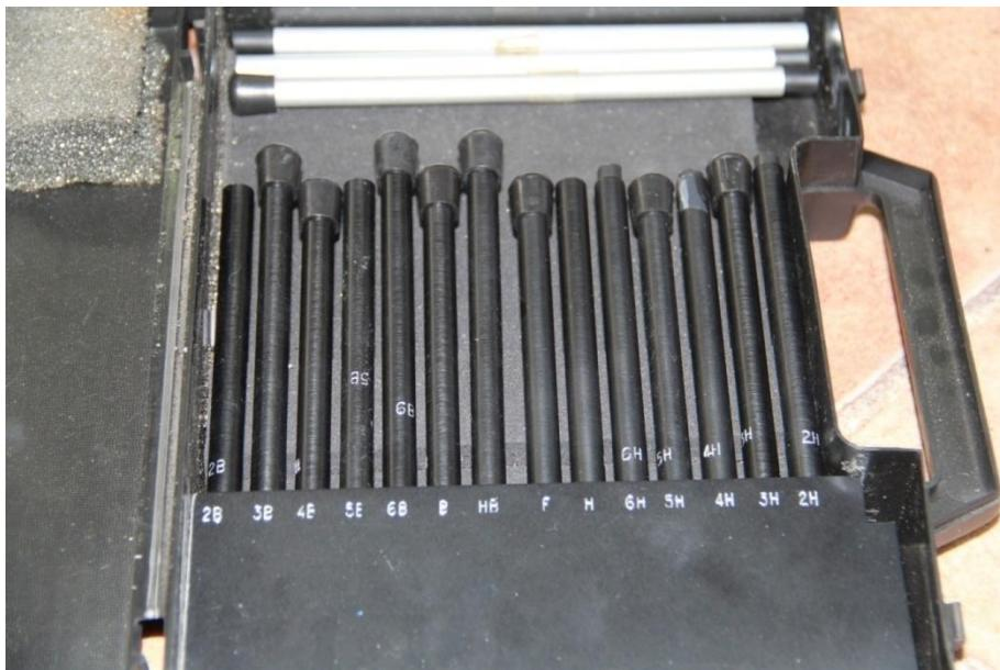
Slika 30. Olovke različitih tvrdoća za ispitivanje tvrdoće premaza
