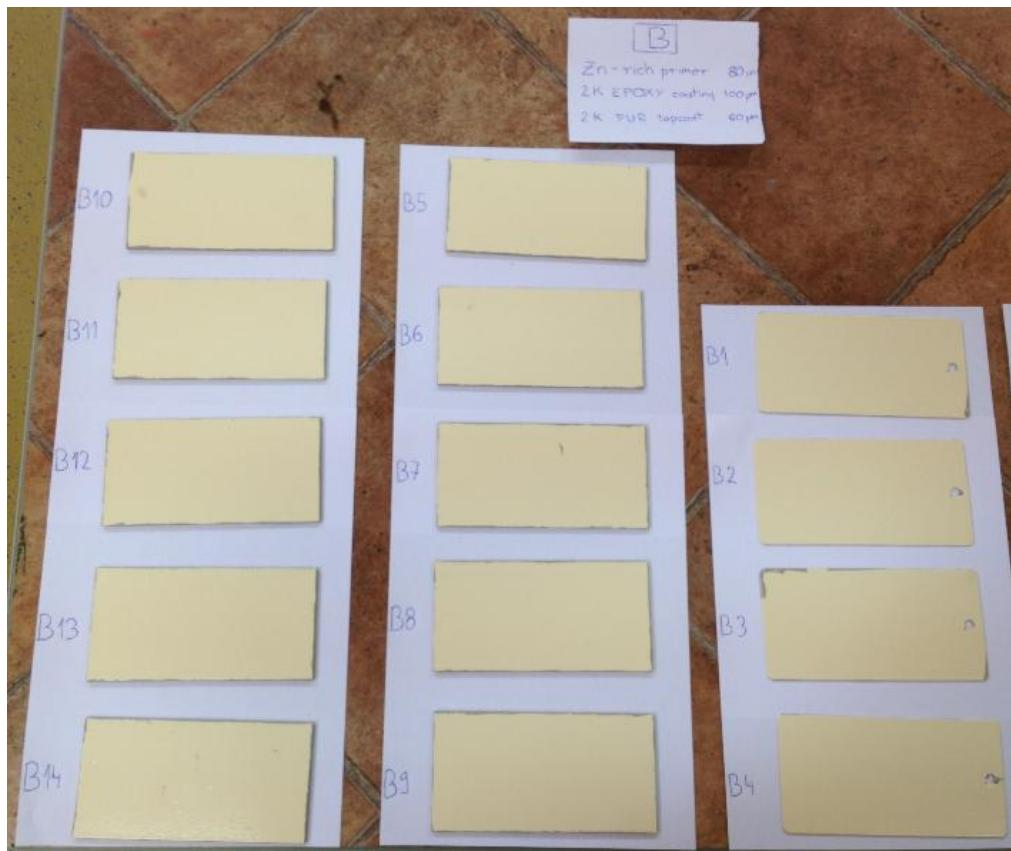
Slika 25. Uzorci sustava premaza B, na bazi otapala
