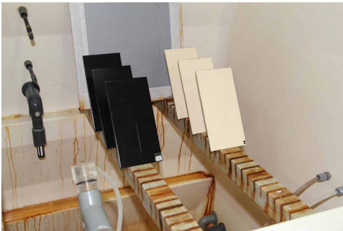
Slika 37. Uzorci sustava premaza A i B prije ispitivanja u slanoj komori
