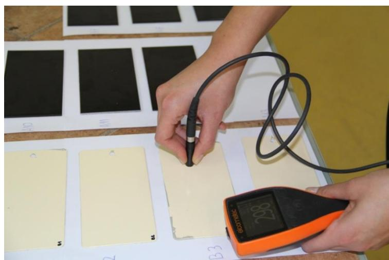
Slika 27. Postupak mjerjenja debljine suhog filma sustava A i B
