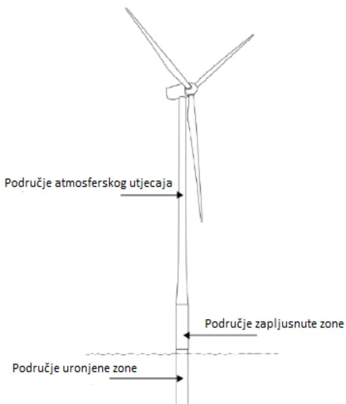
Slika 22. Korozijom zahvaćene zone stupa offshore vjetroagregata [23]
