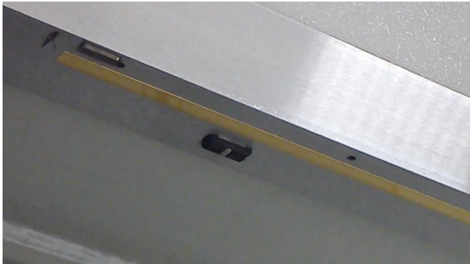
Slika 26. Magnet za inicijalizaciju uz x os TMU Ferranti Merlin 750
