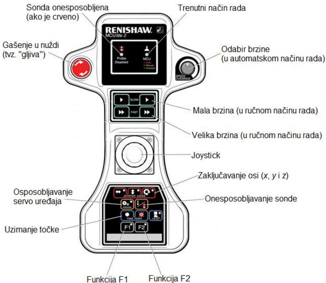
Slika 24. Upravljačka ploča Renishaw MCU lite-2
