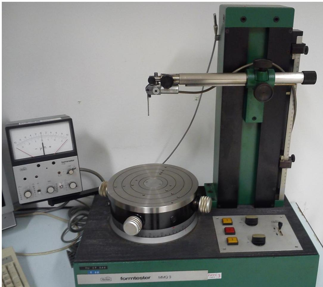
**Slika 12. Uređaj za mjerjenje kružnosti MMQ 3 u Nacionalnom laboratoriju za duljinu**
