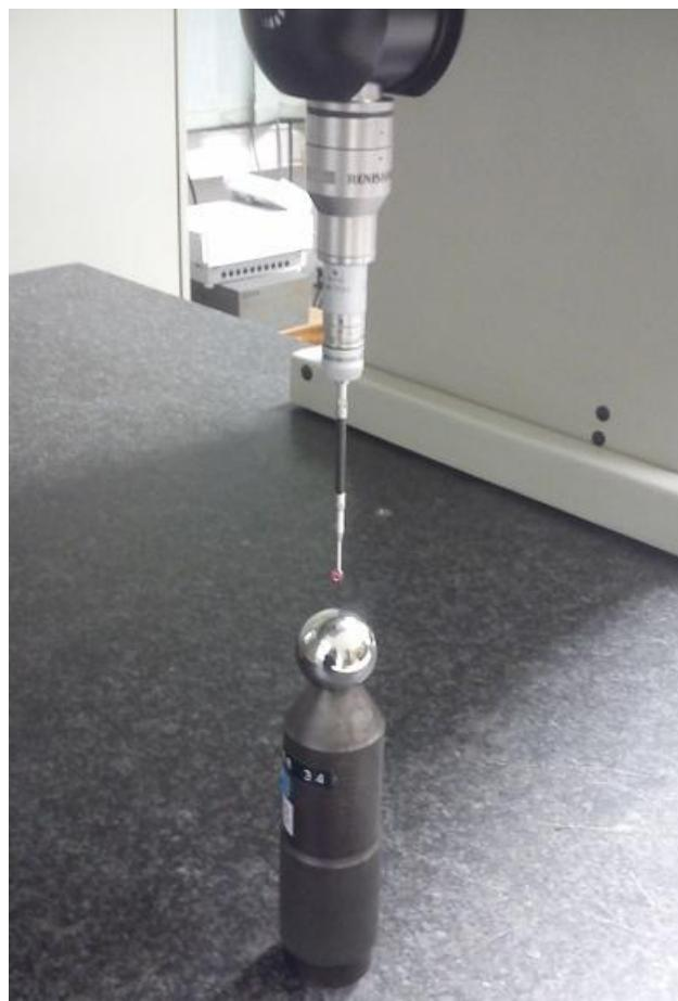
Slika 46. Pozicioniranje ticala prema etalonu za umjeravanje
