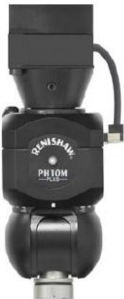
Slika 35. Renishaw PH10M mjerna glava bez priključene sonde
