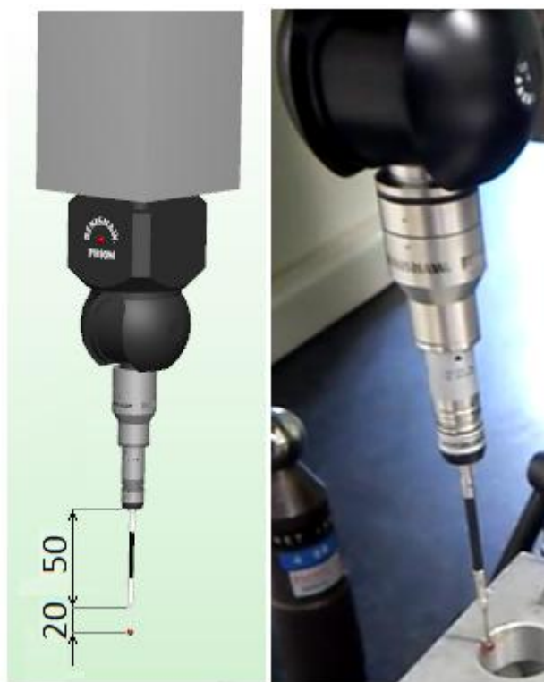
Slika 29. Ticalo Renishaw TP20 50_20x4 (model i fotografija)
