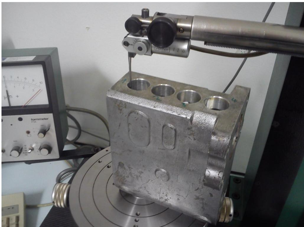
Slika 55. Mjerenje provrta 1 na okretnom stolu
