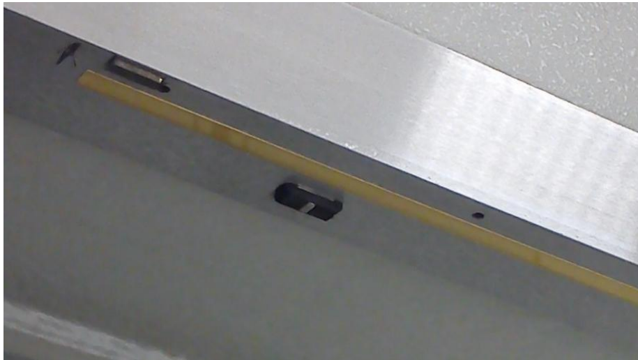
Slika 26. Magnet za inicijalizaciju uz x os TMU Ferranti Merlin 750
