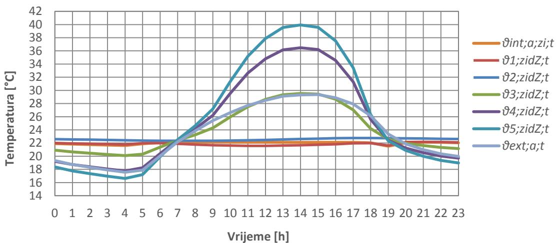
**Dijagram 25. Dnevne raspodjele temperatura svih čvorova vanjskog zida orijentiranog prema zapadu za uprosječeni dan u kolovozu**
