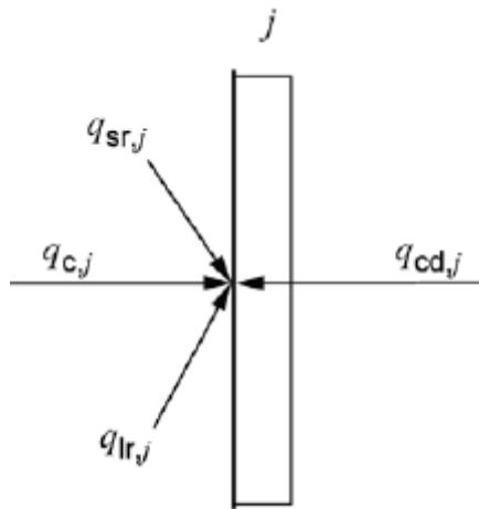
**Slika 7. Toplinski tokovi vanjske površine građevnog elementa**
