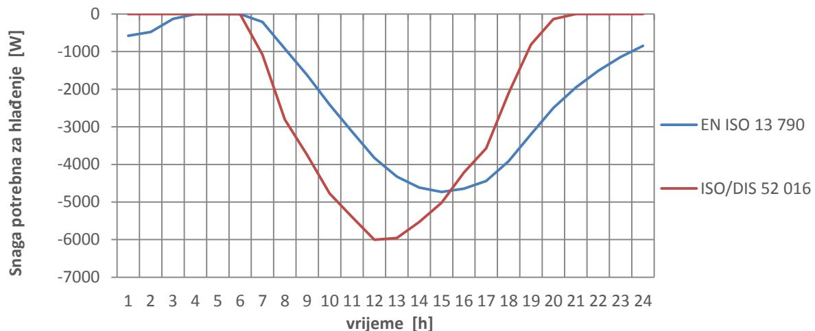
**Dijagram 38. Rezultati potrebne snage za hlađenje za uprosječeni dan u kolovozu prema ISO/DIS 52016-1 i EN ISO 13790 prema 1. slučaju**
