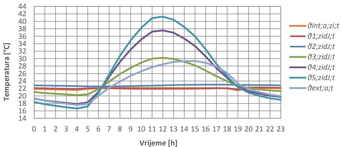
Dijagram 23. Dnevne raspodjele temperature svih čvorova vanjskog zida orijentiranog prema jugu za uprosječeni dan u kolovozu
