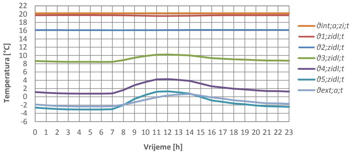
**Dijagram 5. Dnevne raspodjele temperature svih čvorova vanjskog zida orijentiranog prema istoku za uprosječeni dan u siječnju**
