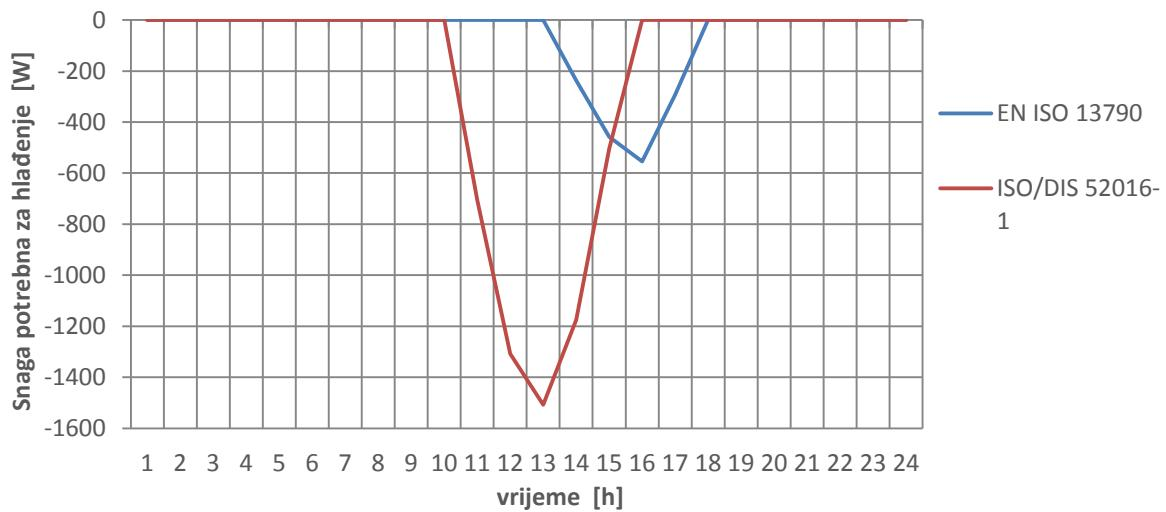
**Dijagram 32. Rezultati potrebne snage za hlađenje za uprosječeni dan u listopadu prema ISO/DIS 52016-1 i EN ISO 13790**
