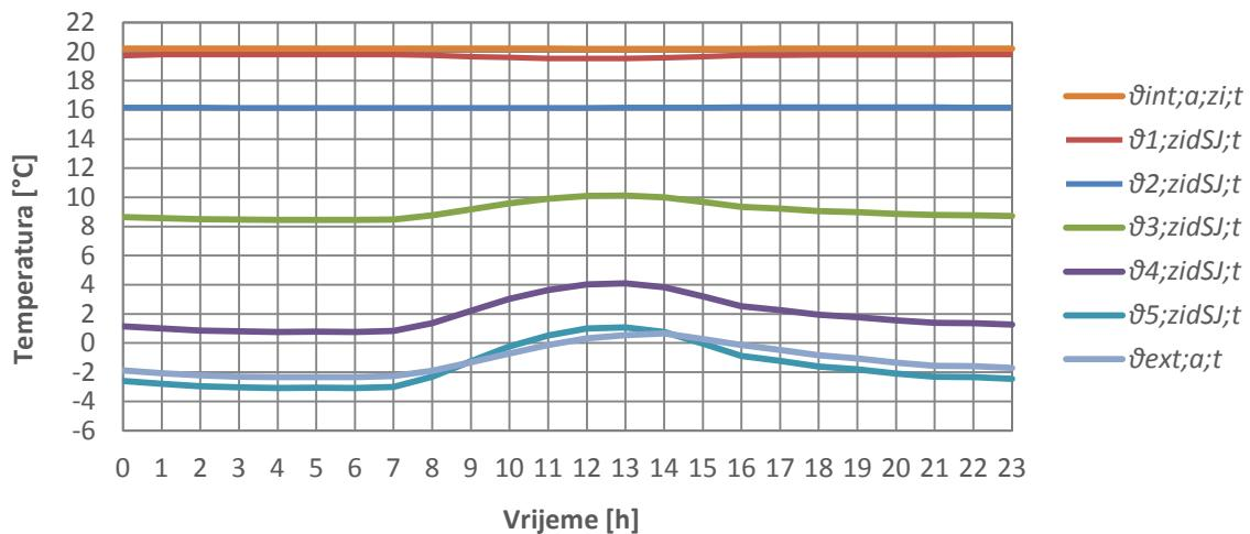
**Dijagram 3. Dnevne raspodjele temperature svih čvorova vanjskog zida orijentiranog prema sjeveru za uprosječeni dan u siječnju**
