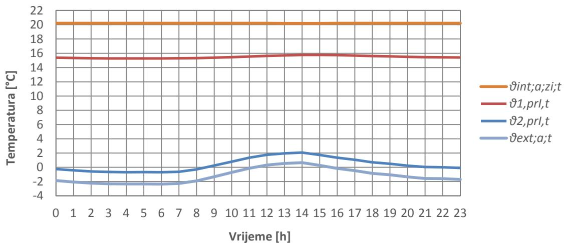
**Dijagram 11. Dnevne raspodjele temperatura površinskih slojeva prozora orijentiranog prema istoku za uprosječeni dan u siječnju**
