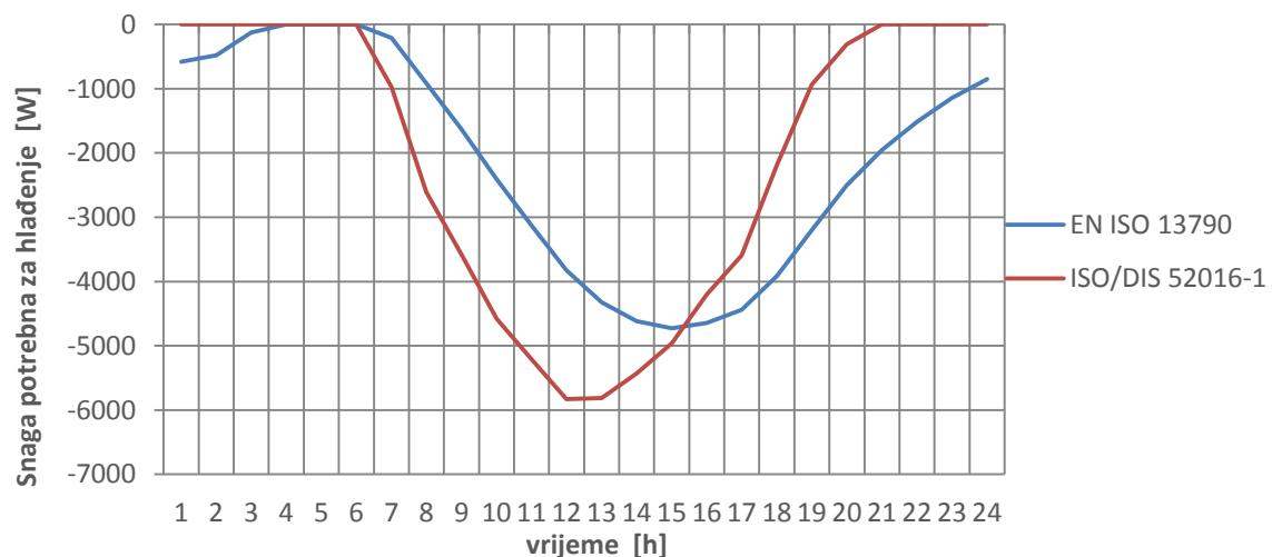
**Dijagram 21. Rezultati potrebne snage za hlađenje za uprosječeni dan u kolovozu prema ISO/DIS 52016-1 i EN ISO 13790**
