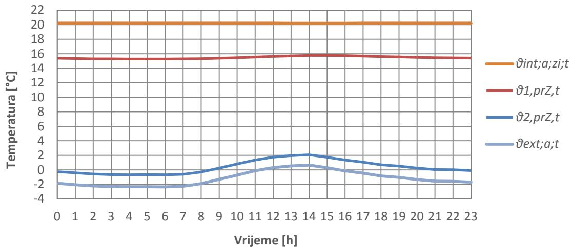
**Dijagram 8. Dnevne raspodjele temperatura površinskih slojeva prozora orijentiranog prema zapadu za uprosječeni dan u siječnju**
