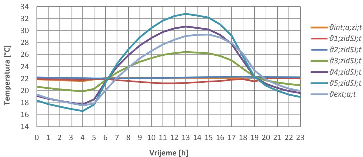
Dijagram 22. Dnevne raspodjele temperature svih čvorova vanjskog zida orijentiranog prema sjeveru za uprosječeni dan u kolovozu
