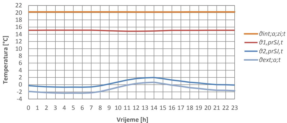
**Dijagram 9. Dnevne raspodjele temperatura površinskih slojeva prozora orijentiranog prema sjeveru za uprosječeni dan u siječnju**
