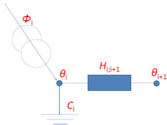
Slika 3. RC model prema normi ISO/DIS 52016-1
