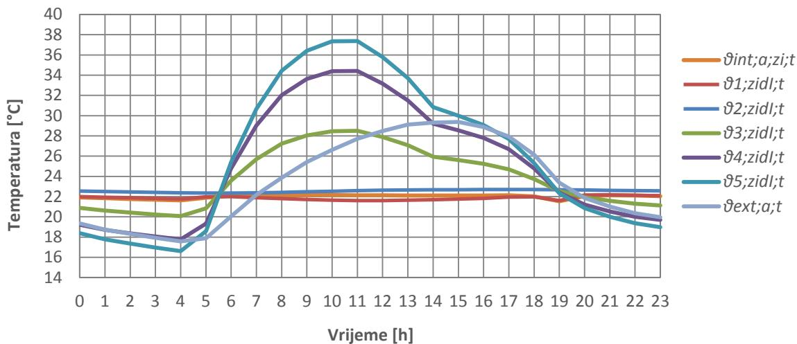
**Dijagram 24. Dnevne raspodjele temperatura svih čvorova vanjskog zida orijentiranog prema istoku za uprosječeni dan u kolovozu**
