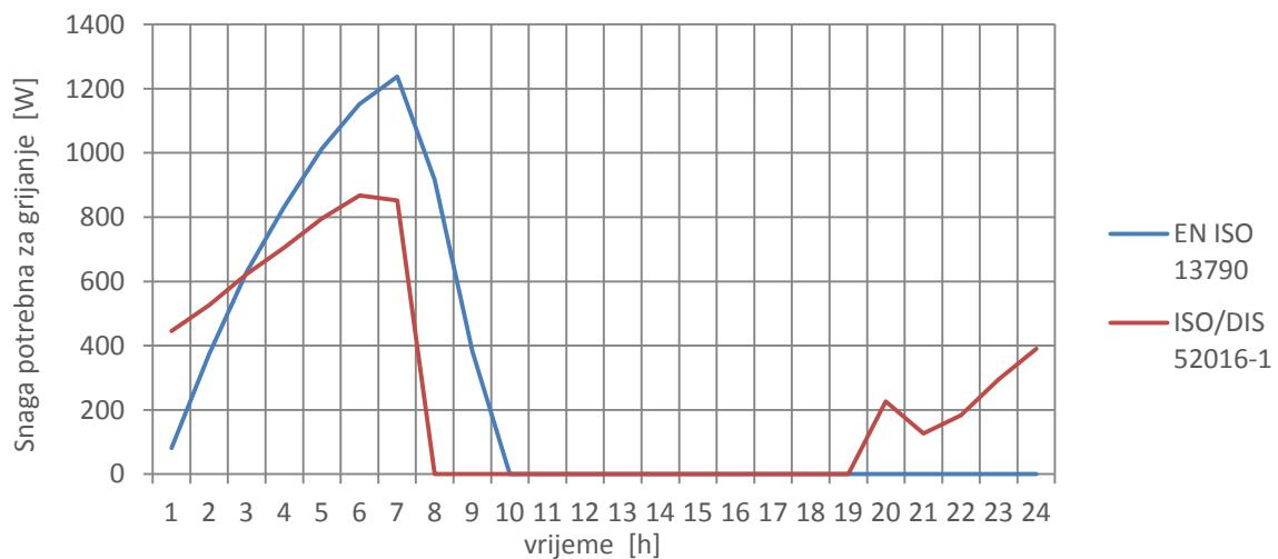
**Dijagram 31. Rezultati potrebne snage za grijanje za uprosječeni dan u listopadu prema ISO/DIS 52016-1 i EN ISO 13790**
