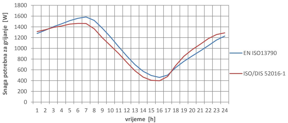
**Dijagram 40.** Rezultati potrebne snage za grijanje za uprosječeni dan u listopadu prema ISO/DIS 52016-1 i EN ISO 13790 prema 2. slučaju
