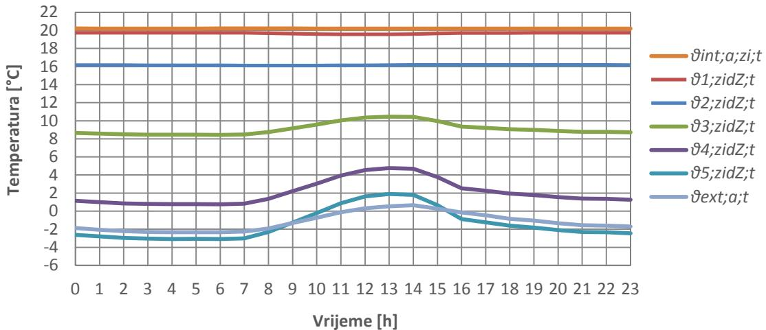
**Dijagram 6. Dnevne raspodjele temperatura svih čvorova vanjskog zida orijentiranog prema zapadu za uprosječeni dan u siječnju**
