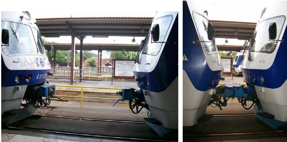
Slika 7. Razdvojene (lijevo) i spojene garniture (desno) HŽ 6111
