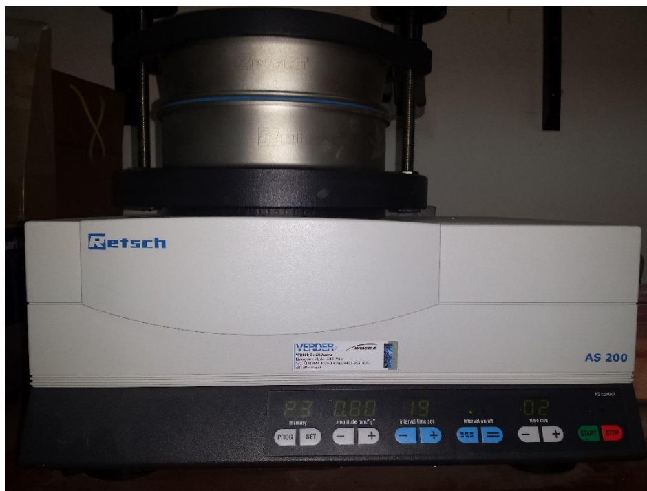
Slika 23. Prosijavanje drvenih čestica na situ RETSCH AS 200
