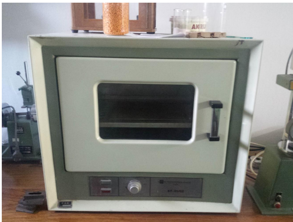
Slika 35. Peć korištena za umrežavanje kompozita
