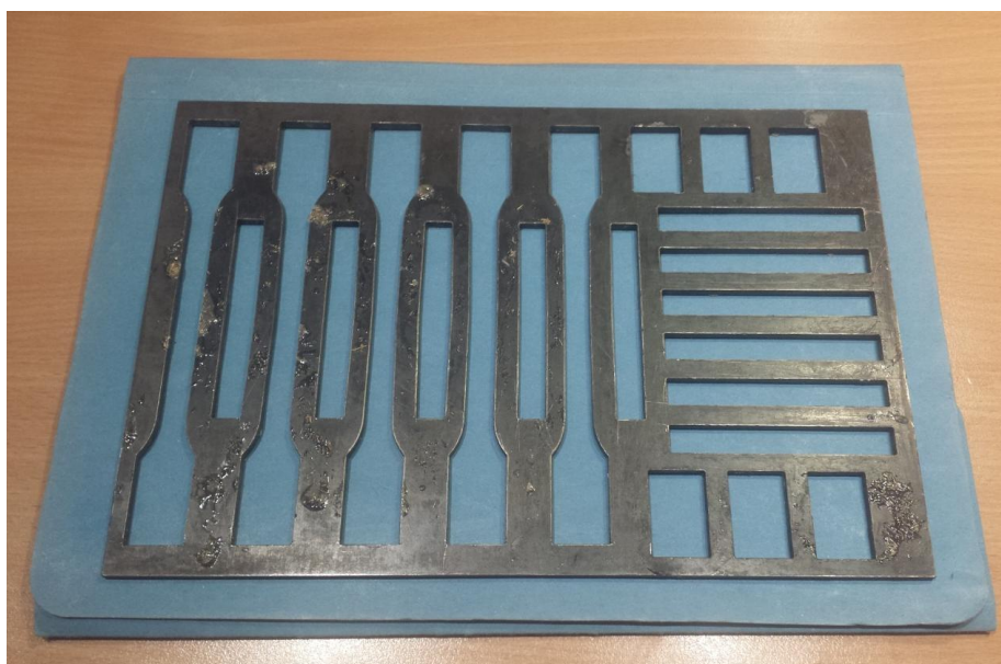
Slika 32. Kalupni okvir za izradu ispitnih tijela
