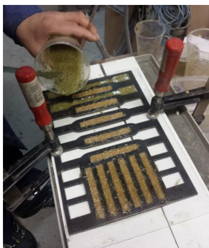
Slika 34. Priprema kalupa i ulijevanje suspenzije
