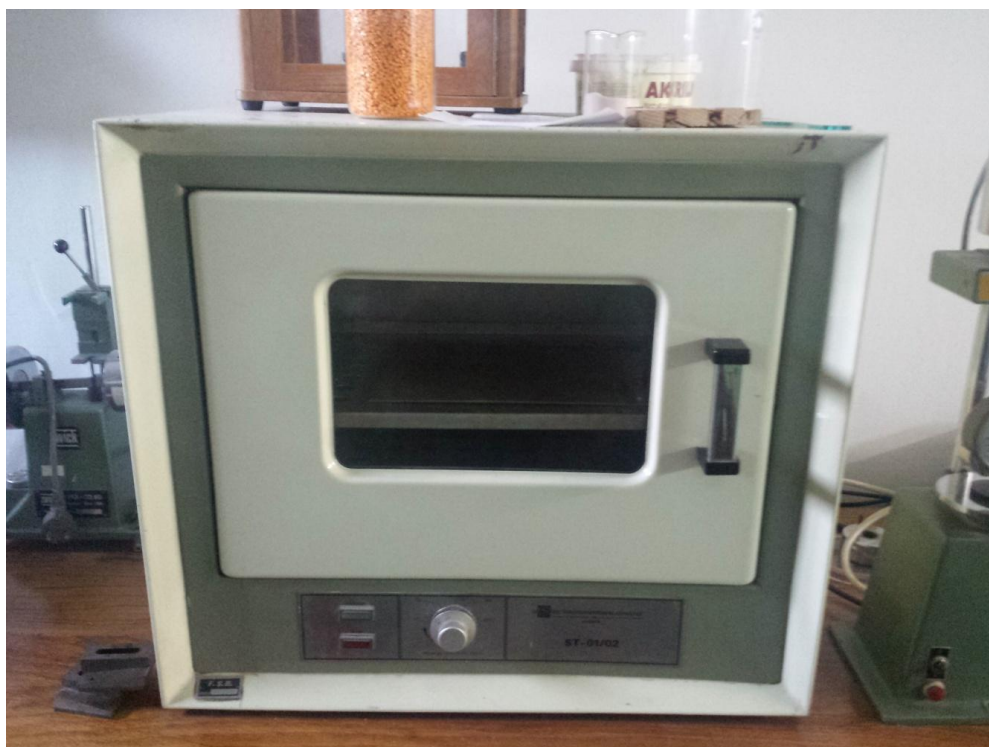
Slika 35. Peć korištena za umrežavanje kompozita
