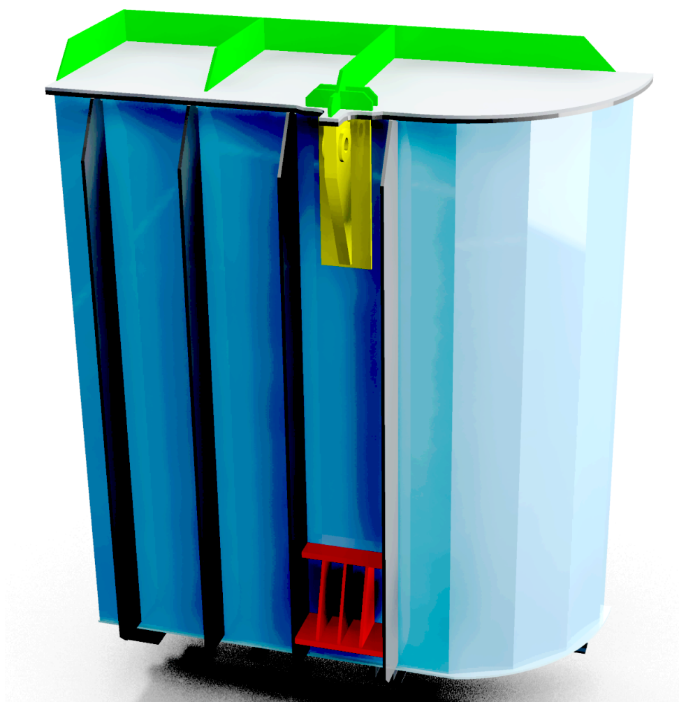
Slika 14. Proračunski model transformatora s novim zavjesnim elementima
