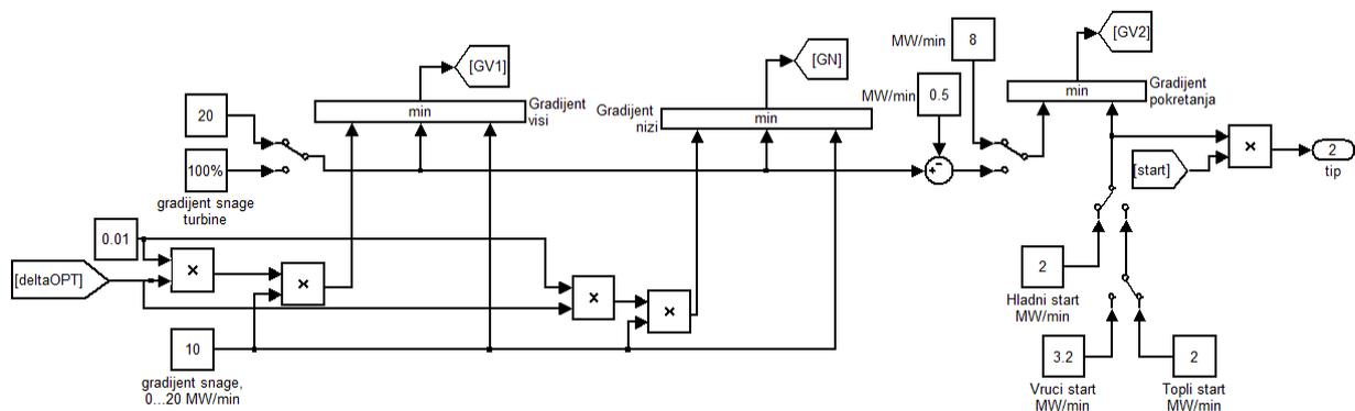
Slika 31. Sklop za formiranje gradijenata ostvarive snage
