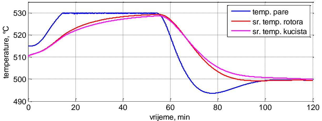
**Slika 50. Promjena temperature pare, te srednjih temperatura rotora i kućišta**
