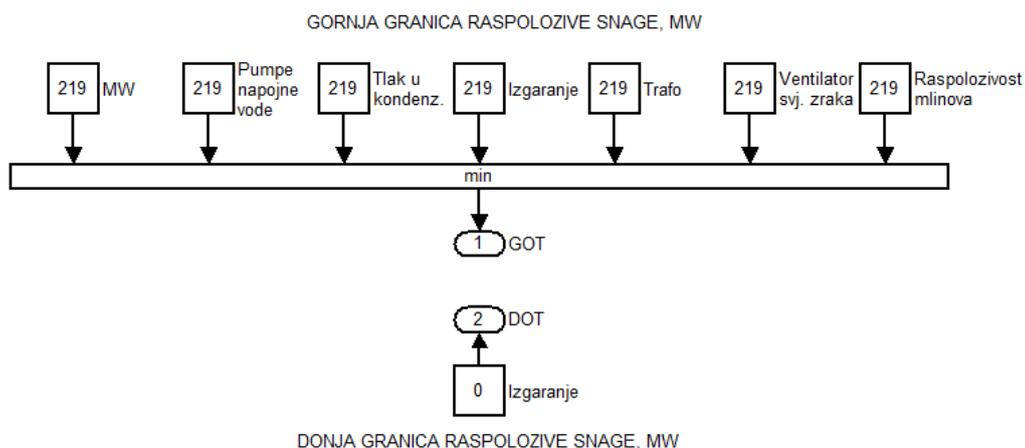
Slika 30. Sklop za formiranje signala ostvarive snage
