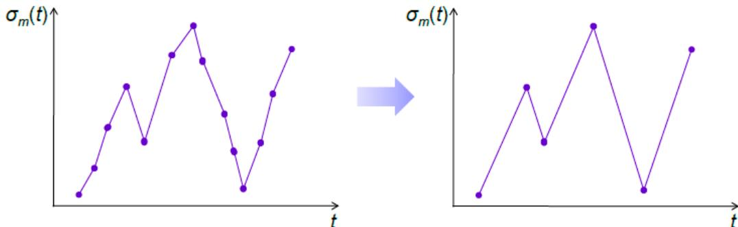
**Slika 60. Naprezanja u materijalu i otkrivene ekstremne vrijednosti naprezanja [8]**
