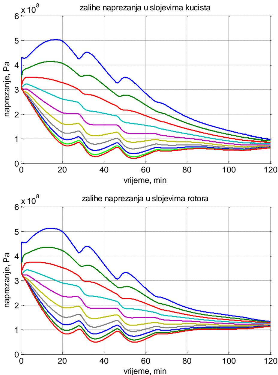
**Slika 38. Usporedba zaliha naprezanja kod hladnog starta**
