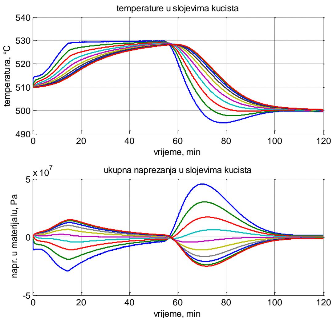
**Slika 52. Temperature i naprezanja u slojevima rotora**
