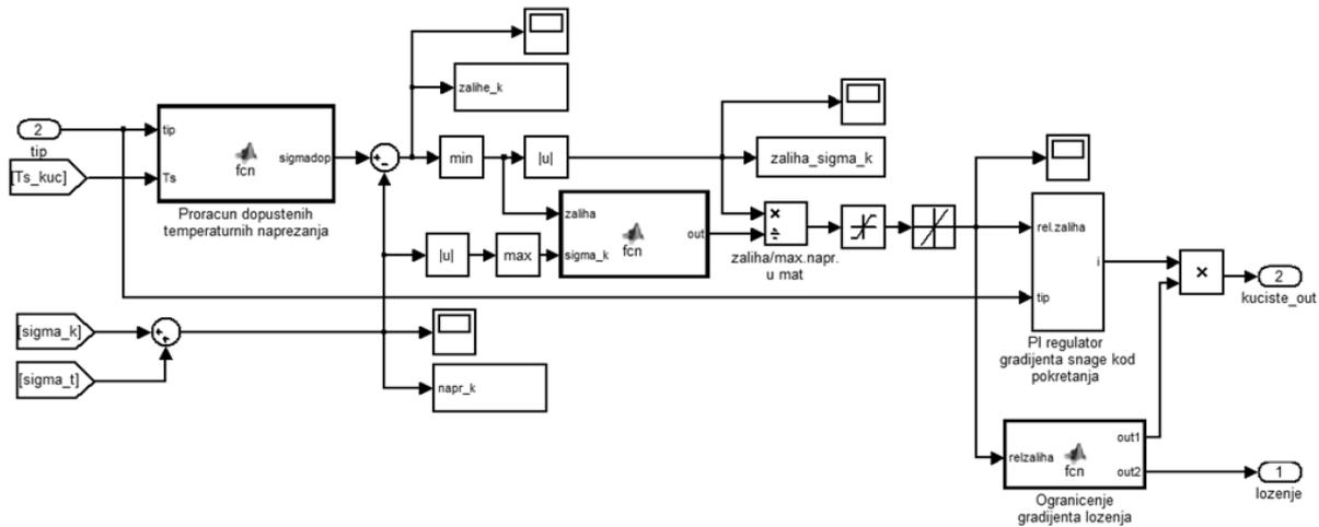
**Slika 33. Ograničenje porasta snage kod promjene opterećenja bloka**
