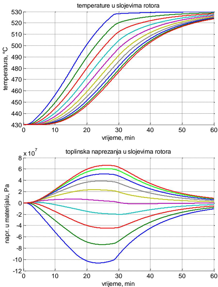
**Slika 45. Temperature i toplinska naprezanja u slojevima rotora kod vrućeg starta**
