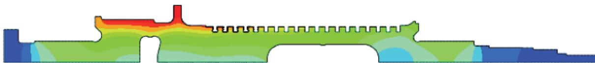
**Slika 1. Temperaturno polje unutar rotora tijekom progrijavanja turbine [11]**
