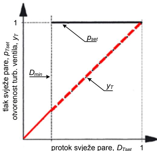
Slika 16. Karakteristika pogona s konstantnim tlakom [8]
