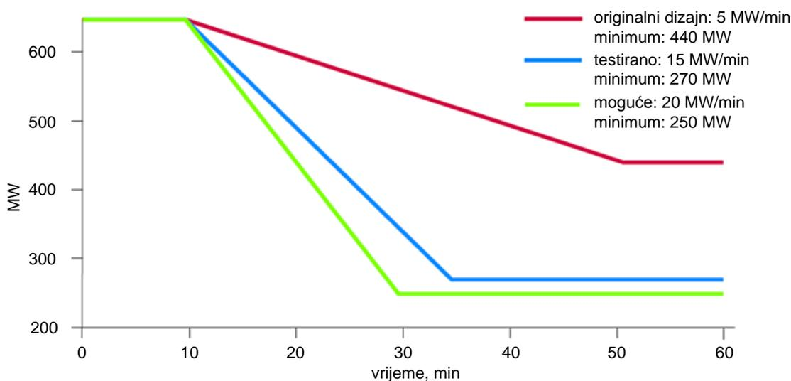
**Slika 7. Primjer poboljšanja na TE bloku nakon promjene upravljačkog sustava [4]**
