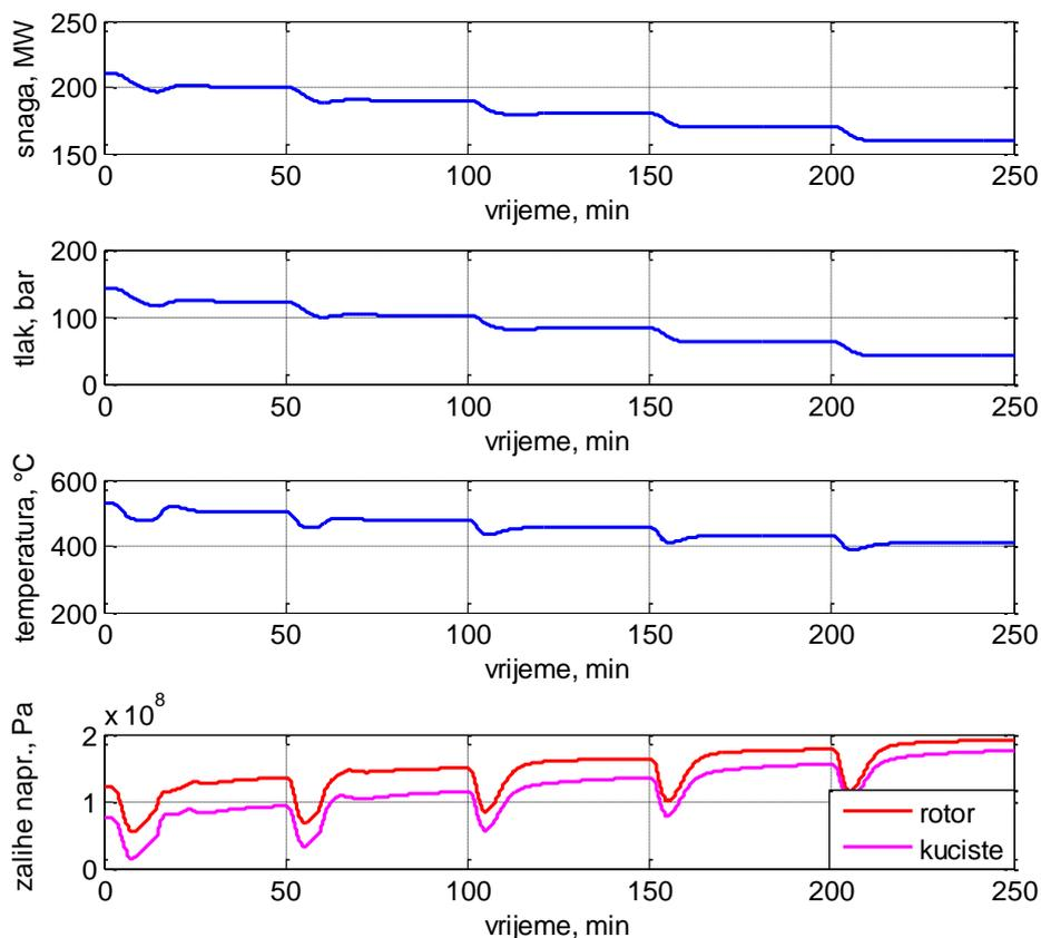
Slika 61. Simulacija postupne promjene snage bloka
