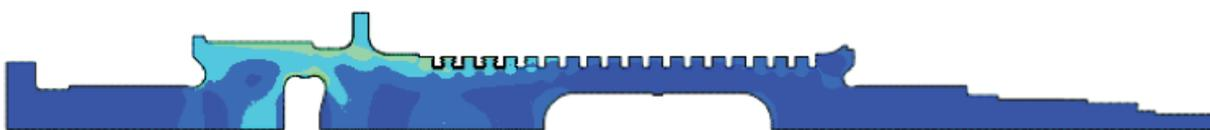
**Slika 2. Polje naprezanja unutar rotora tijekom progrijavanja turbine [11]**
