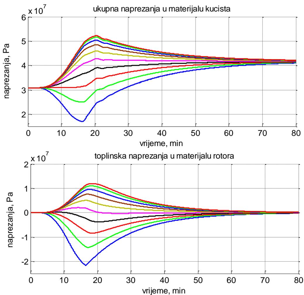
**Slika 57. Naprezanja u slojevima kućišta u režimu s modificiranim kliznim tlakom**
