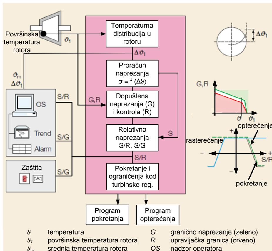
Slika 32. Blok dijagram programa za nadzor turbinskih naprezanja [10]
