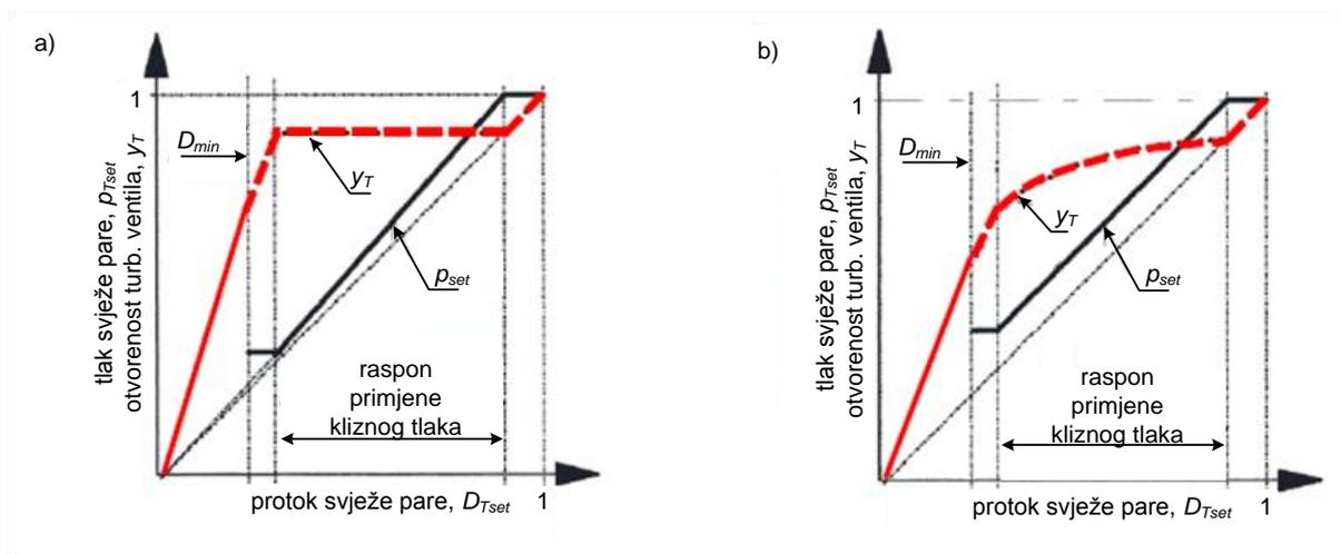
**Slika 18. Karakteristike pogona s modificiranim kliznim tlakom [8]**
