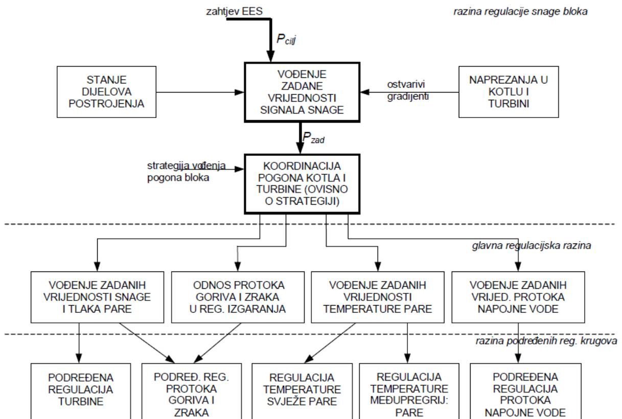
Slika 27. Hijerarhijska struktura suvremenog regulacijskog sustava TE bloka [6]
