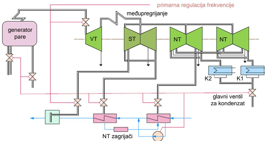
**Slika 9. Kondenzat-stop metoda za postizanje brzih odziva [4]**
