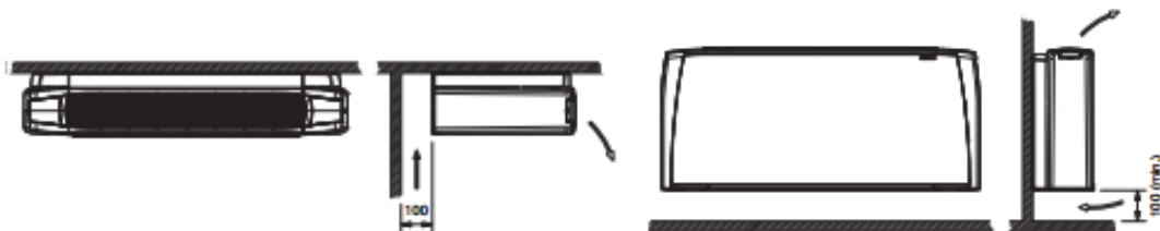
Slika 18. Načini ugradnje ventilokonvektora [7]
