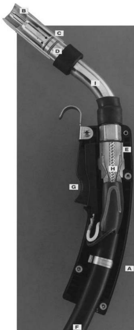
Slika 2.17. Poprečni presjek tipičnog pištolja za MIG/MAG zavarivanje: A – ergonomski oblikovana drška; B – kontaktna vodilica; C – sapnica plina; D – plinski difuzor; E – konektor za napajanje; F – središnje crijevo koje sadrži crijevo za plin/polikabel; G – prekidač; H – zamjenjiva košuljica; I – prilagodljiva mlaznica [2]
