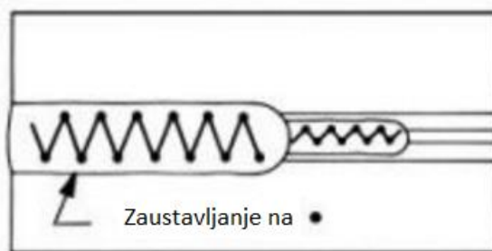
Slika 2.16. Tehnika njihanja kod nadglavnog zavarivanja [8]
