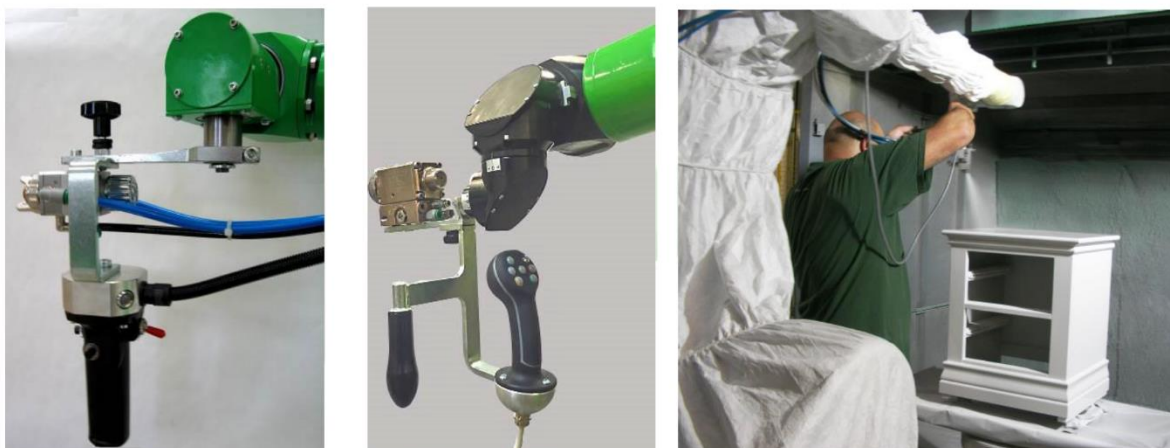
Slika 3.6. Programiranje kretanjem po stazi i upravljač na robotskoj ruci [18]
