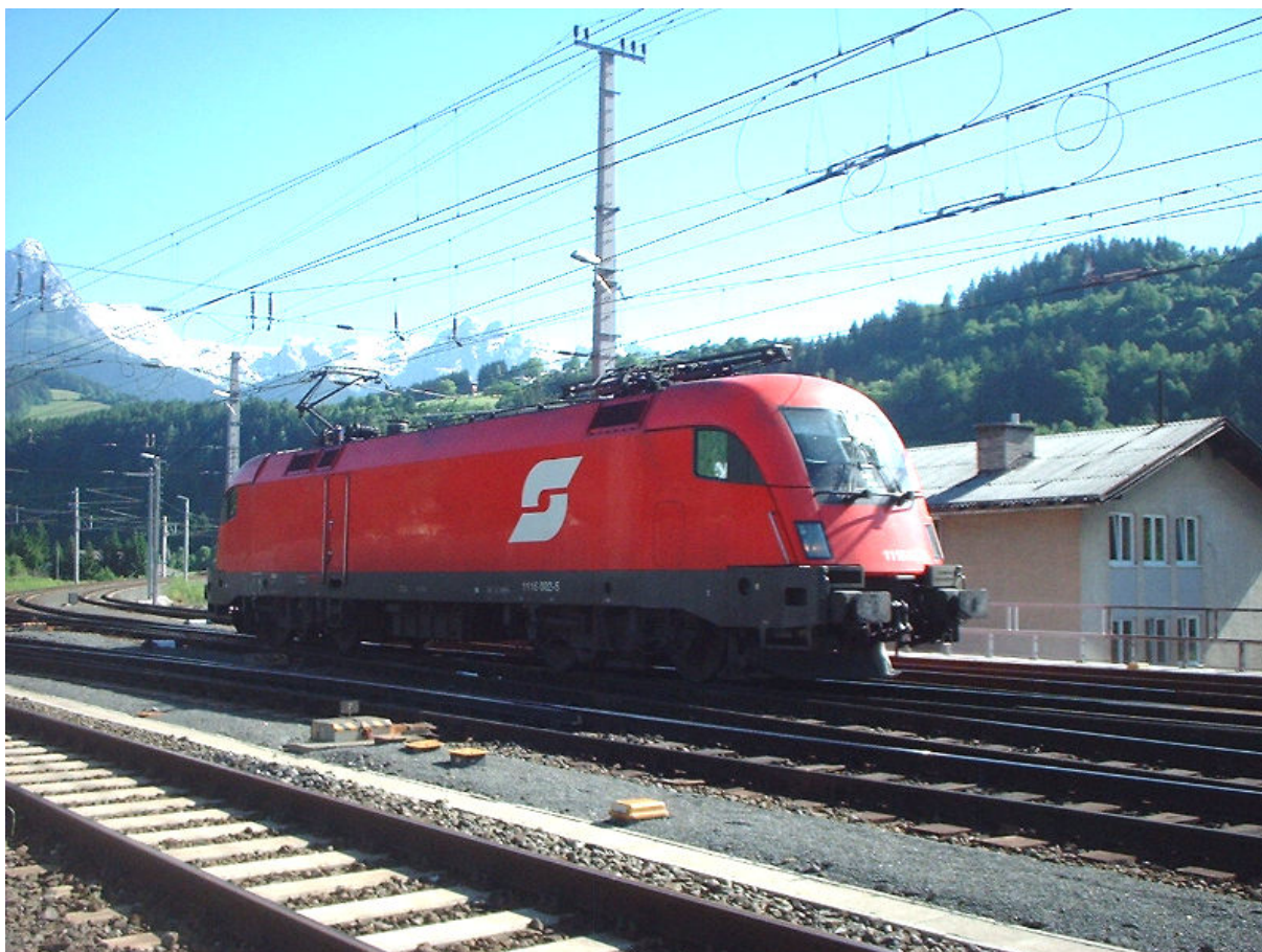
Sl.3. Univerzalna lokomotiva OBB1116 za vuču teških teretnih vlakova i brzih putničkih sa višesutavnim napajanjem sa sva četiri sustava
