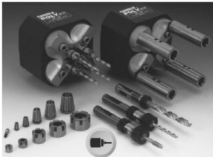
Slika 33. Prikaz viševretene glave sa svrdlima za bušenje [20]
