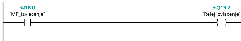
Network 7: <Osiguranje> Ako je aktivan MP za uvlačenje onda se isključuje pripadajuci relej (normalno zatvoreni kontakt omogućava uvlačenje)
