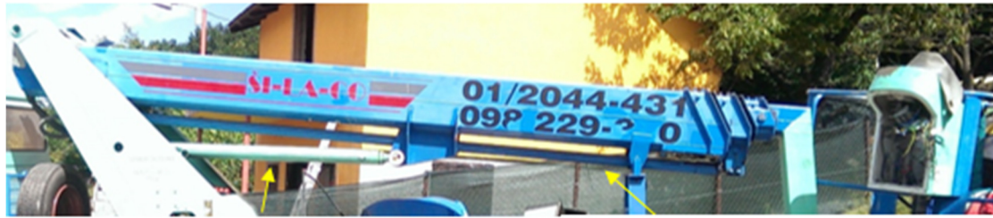
Hidraulički cilindar za podizanje teleskopa radne platforme
