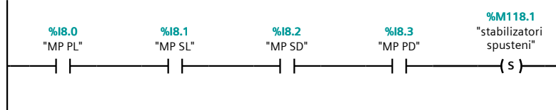
Network 6: Ako se iti jedan stabilizator odvoji od podloge od se isključuje signal "stabilizatori spusteni"
