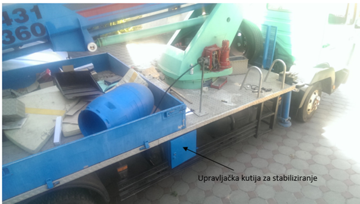
Slika 5. Lokacija ormara za stabilizaciju/nivelaciju
