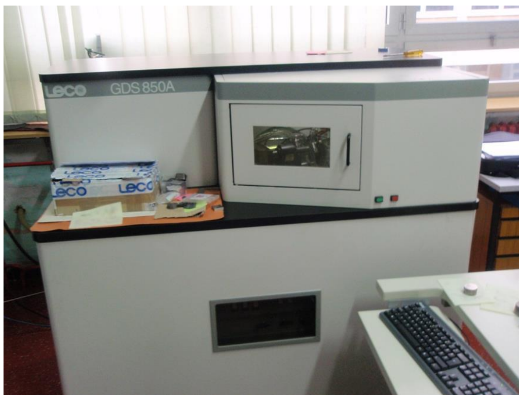
Slika 36. Uređaj LECO GDS 850A za optičku emisijsku spektrometriju
