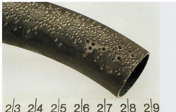
Slika 13. Rupičasta korozija na titanu i titanovim legurama [6]
