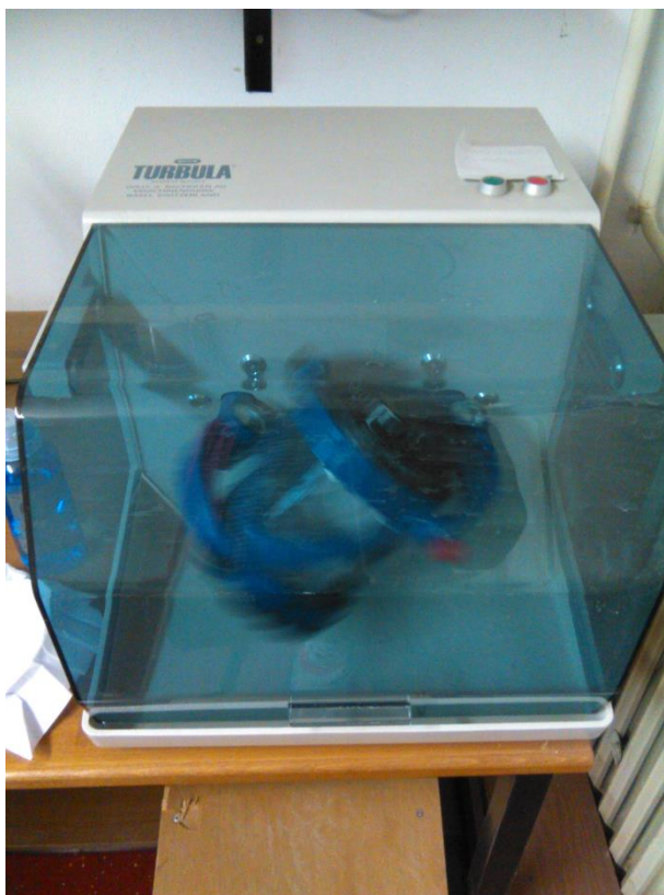
Slika 32. Uređaj „Shaker Mixer Type T2F“ za miješanje prahova
