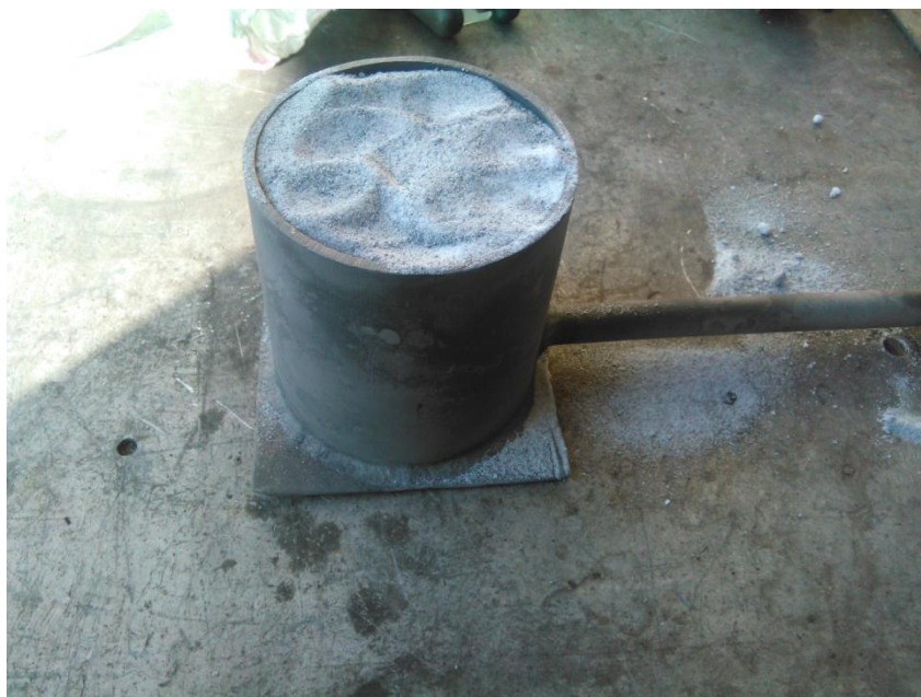
Slika 34. Pripremljena retorta s uzorcima i smjesom prahova za aluminiziranje
