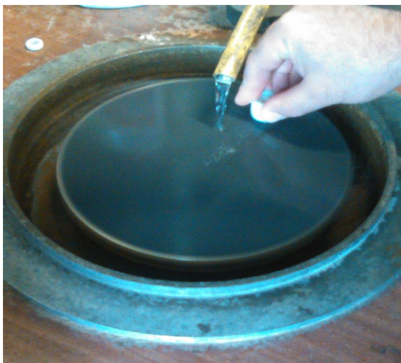
Slika 31. Prikaz ručnog poliranja uzoraka
