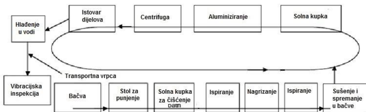
Slika 18. Shematski prikaz automatizirane proizvodnje aluminijskih prevlaka [15]
