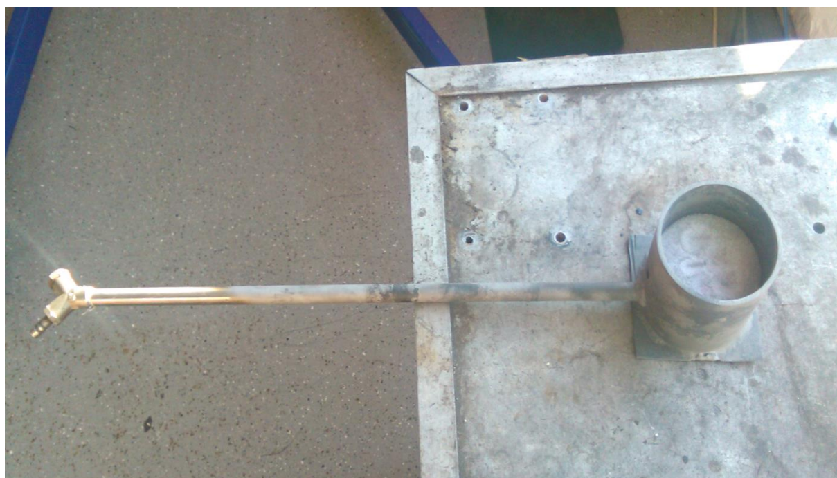
Slika 33. Retorta korištena za aluminiziranje uzoraka
