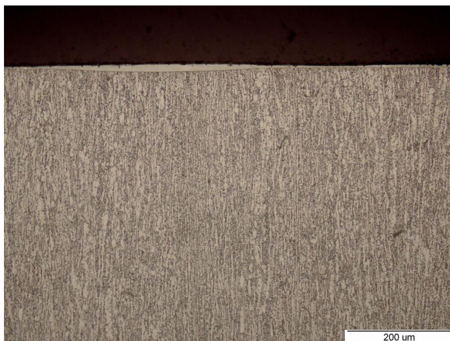
Slika 49. Mikrostruktura rubnog sloja na uzorku legure Ti6Al4V aluminizirane pri 640 °C u trajanju 6 sati, nagriženo u NITAL-u
