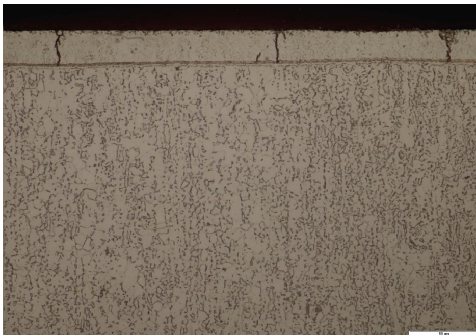
Slika 52. Mikrostruktura rubnog sloja, 500x
