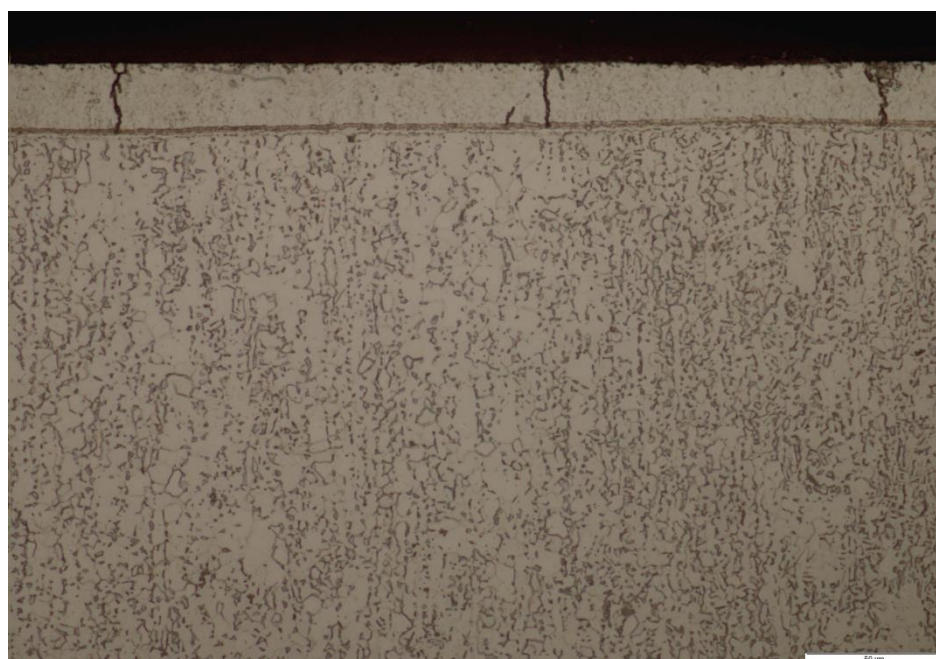
Slika 52. Mikrostruktura rubnog sloja, 500x
