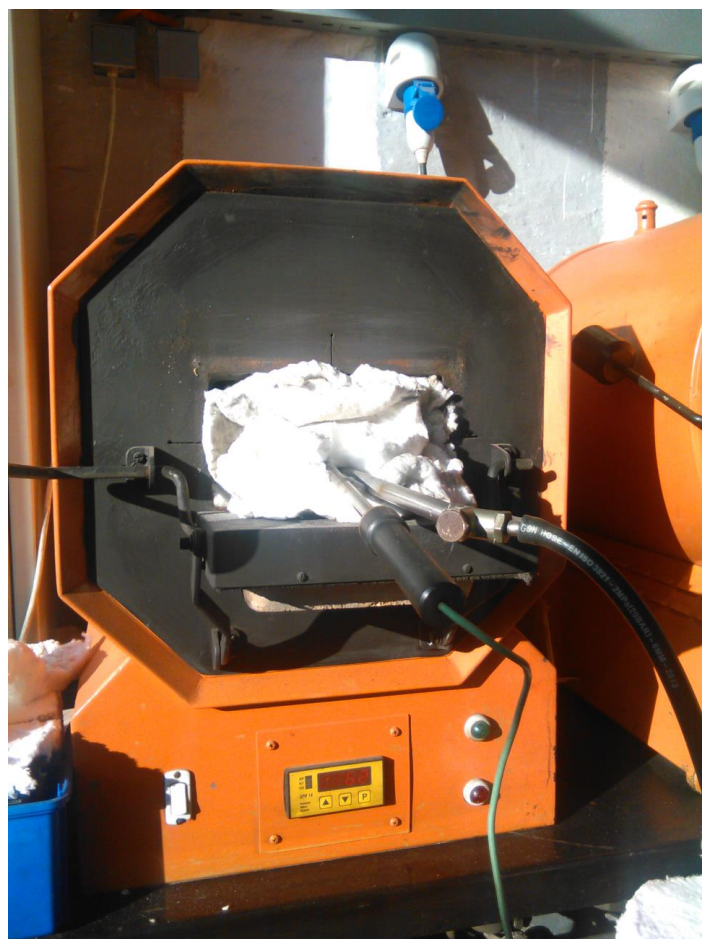
Slika 35. Peć s retortom i sondom za mjerenje temperature tijekom postupka aluminiziranja
