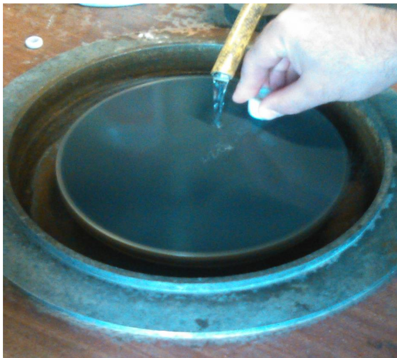
Slika 31. Prikaz ručnog poliranja uzoraka
