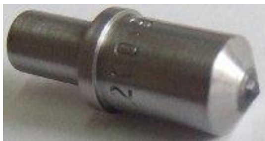
Slika 13. Prikaz indentora kod Rockwellove metode
