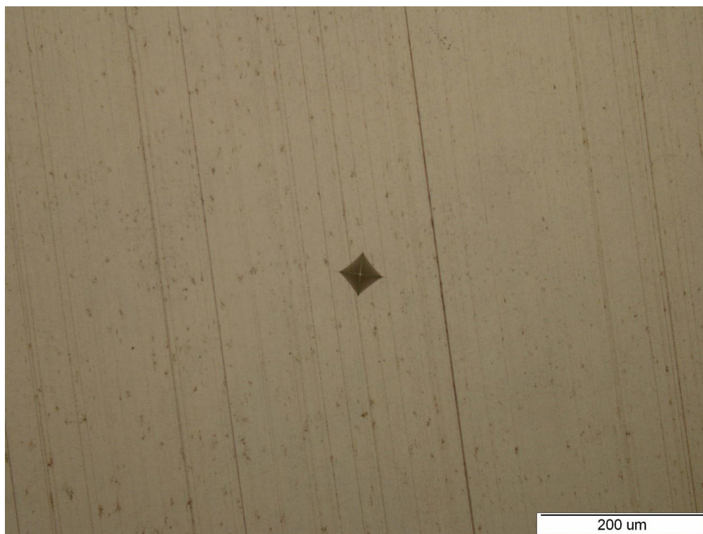
Slika 20. Otisak dijamentne piramide i pukotina kod metode HV3
