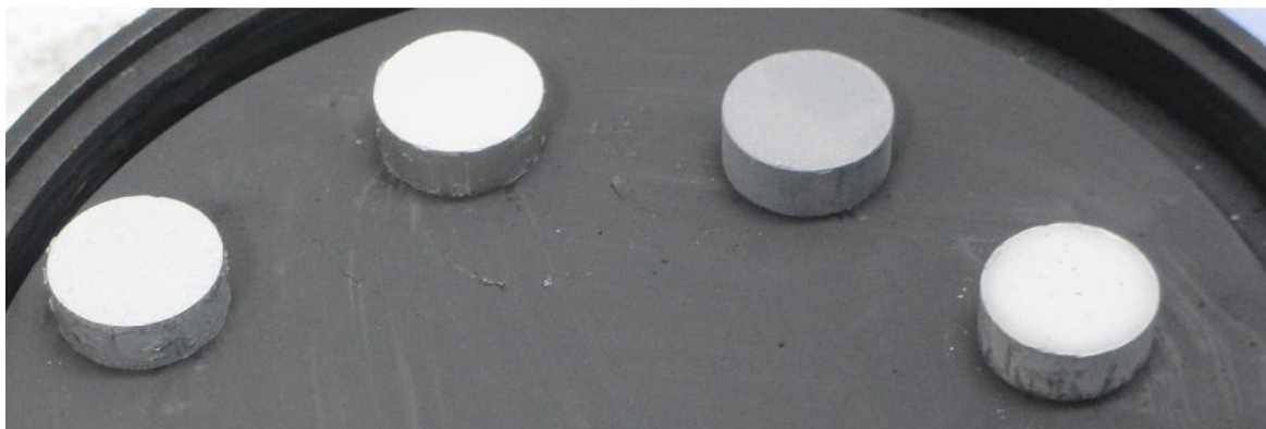
Slika 18. Uzorci tvrdog metala dobiveni sinter-HIP-om [14]
