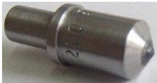
Slika 13. Prikaz indentora kod Rockwellove metode
