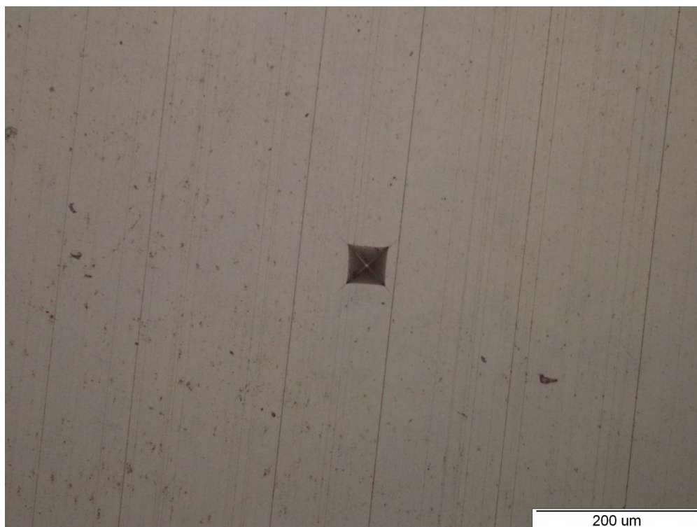
Slika 21. Otisak dijamentne piramide i pukotina kod metode HV5
