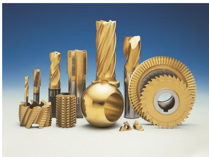
Slika 10. Alati prevučeni TiN prevlakom [10]
