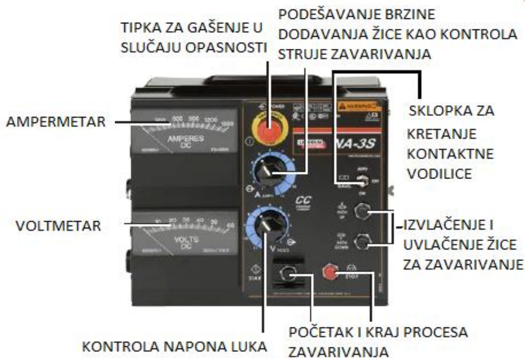
Slika 28. Automatizirani sustav za dodavanje žice „Lincoln electric NA – 3S“ [17]
