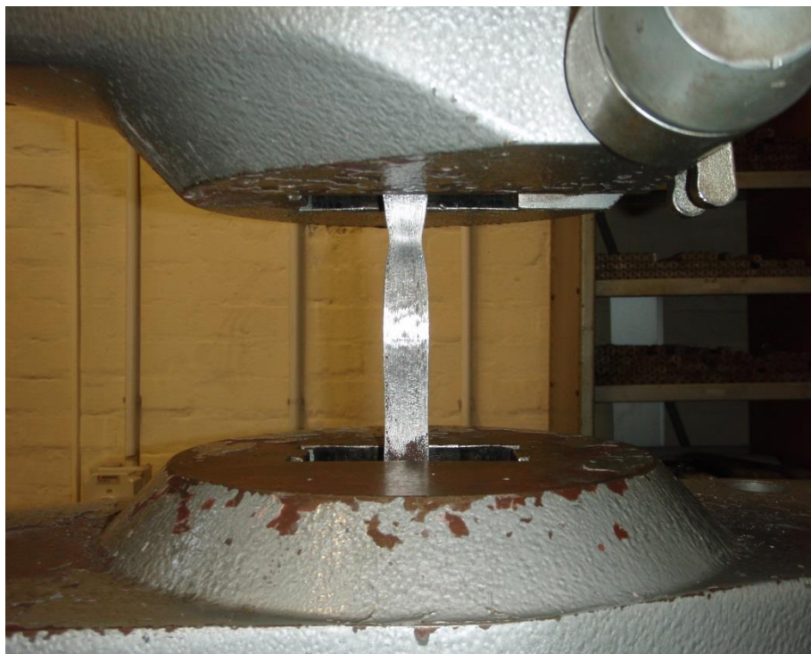
Slika 59. Ispitni uzorak u čeljustima kidalice [29]
