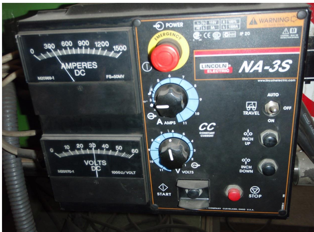
Slika 46. Vrijednosti struje i napona prilikom EPP zavarivanja [29]
