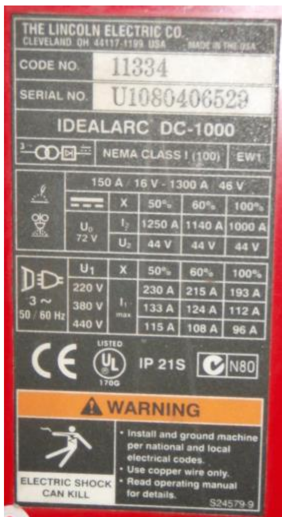
Slika 42. Identifikacijska pločica uređaja Lincoln Electric, Idealarc – DC 1000 [29]
