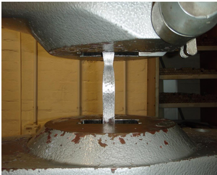
Slika 59. Ispitni uzorak u čeljustima kidalice [29]
