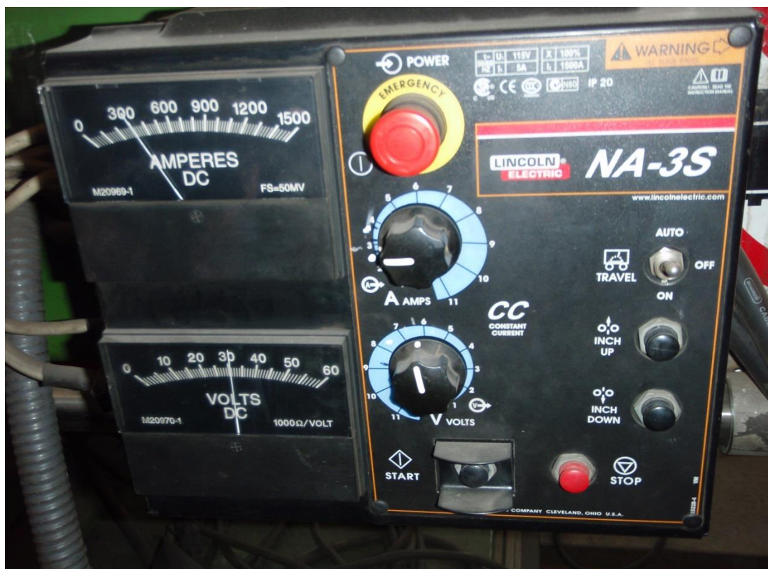
Slika 46. Vrijednosti struje i napona prilikom EPP zavarivanja [29]
