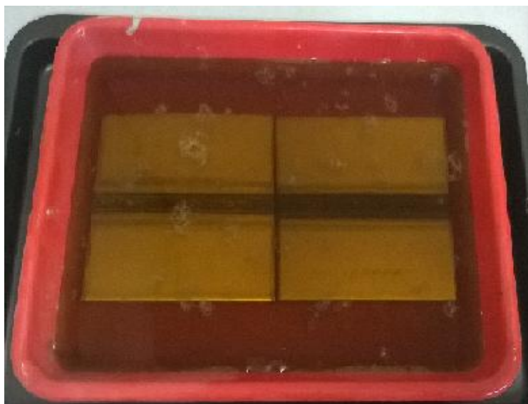
Slika 48. Uzorci uronjeni u agresivnu otopinu
