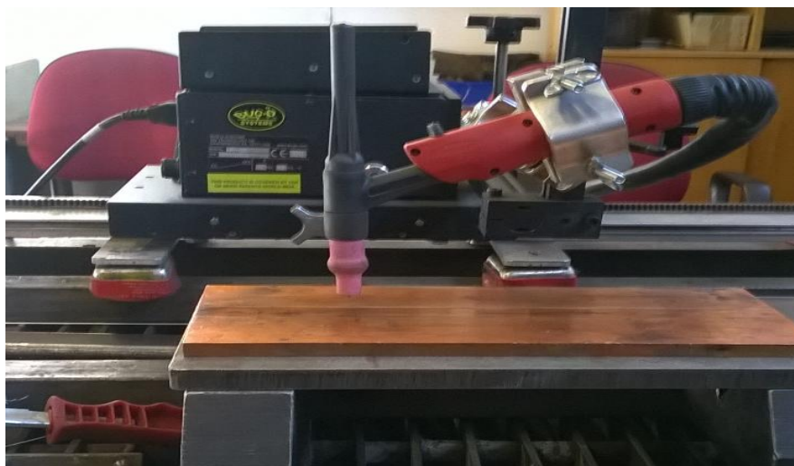
Slika 31. Uređaj za automatiziranje procesa zavarivanja „BUGO Systems“
