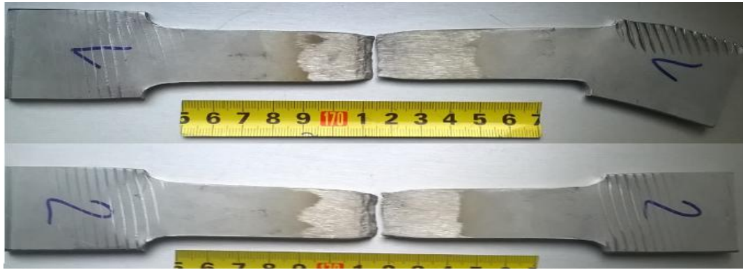
Slika 45. Izgled epruvete nakon kidanja
