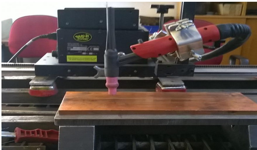
Slika 31. Uređaj za automatiziranje procesa zavarivanja „BUGO Systems“
