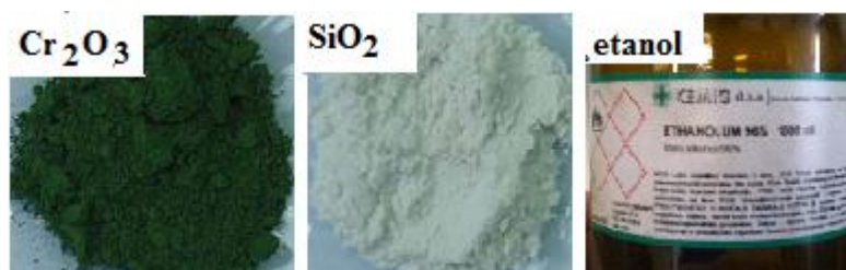
Slika 29. Komponente primjenjenog aktivacijskog premaza
