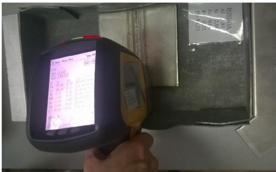
Slika 50. Mjerenje kemijskog sastava uređajem Olympus InnovX
