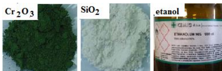
Slika 29. Komponente primjenjenog aktivacijskog premaza
