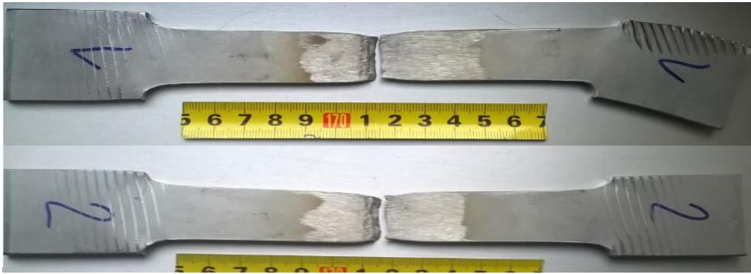
Slika 45. Izgled epruvete nakon kidanja
