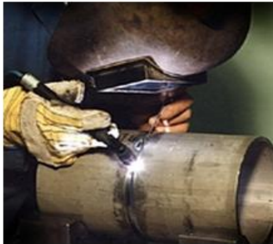
Slika 7. Ručno TIG zavarivanje [18]
