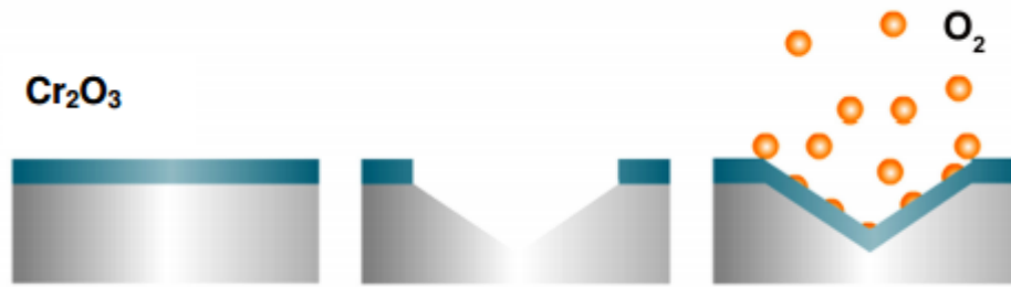
Slika 1. Prikaz mehanizma samoobnavljanja pasivnog filma kromovih oksida na površini [2]
