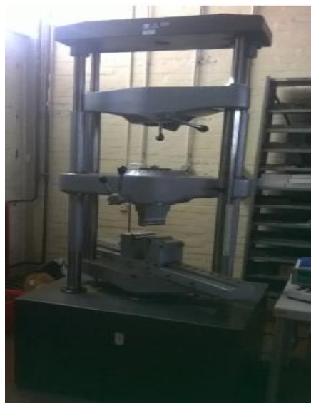
Slika 43. Kidalica EU 40 mod
