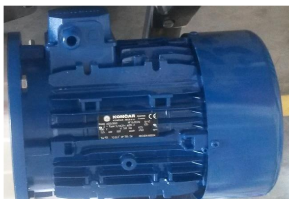
Slika 9. Elektromotor 5AZH 112M-4
