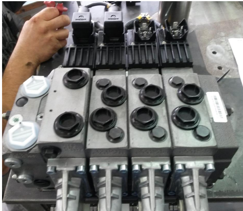
Slika 35. Spajanje električnog pogona razvodnika
