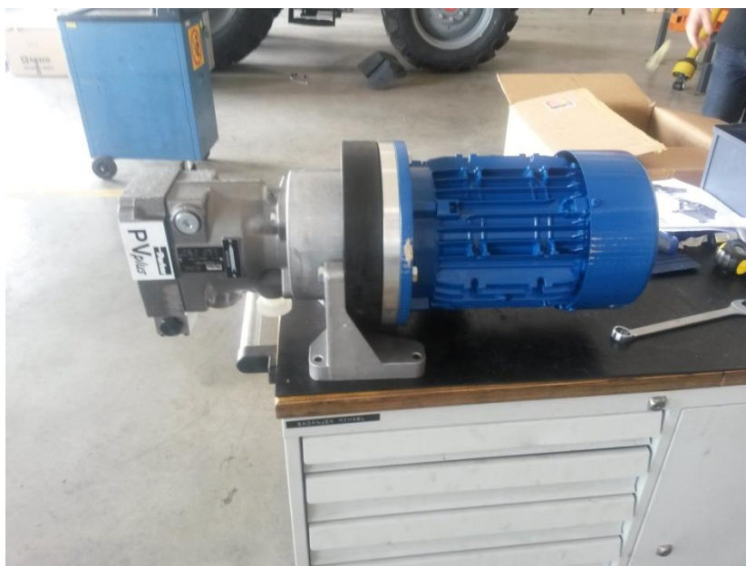
Slika 31. Elektromotor i LS pumpa
