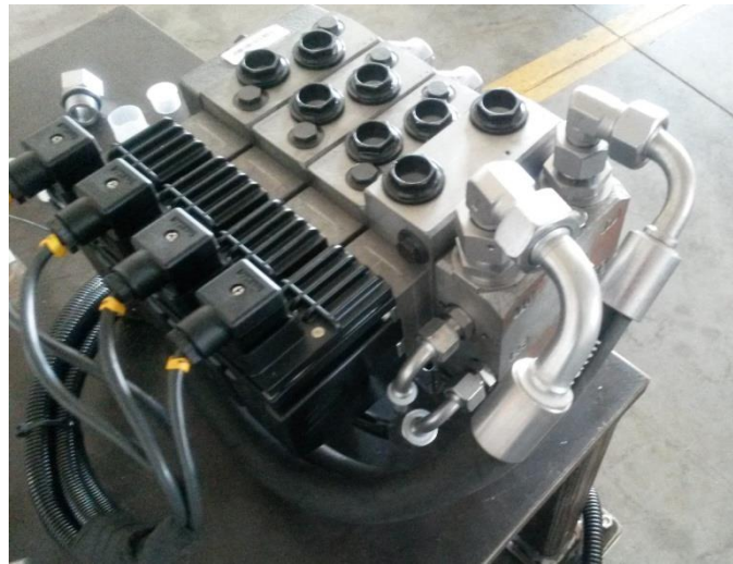
Slika 37. Spajanje razvodnika sa pumpom
