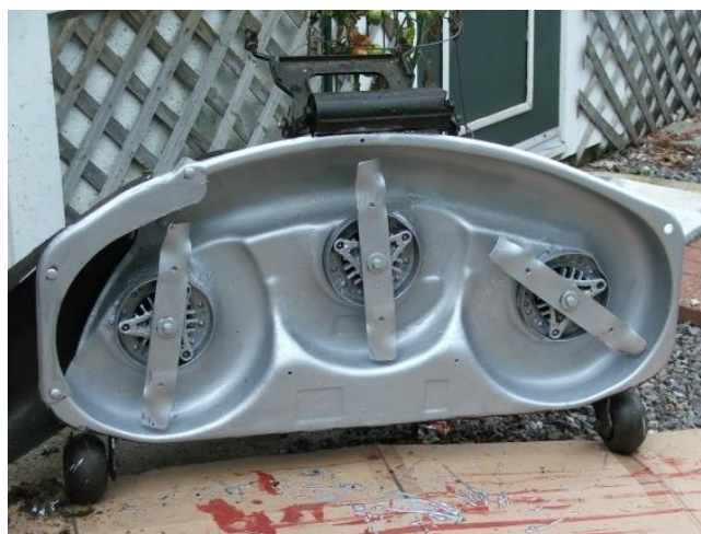
Slika 35. Primjer upotrebe anorganskih premaza s visokim udjelom cinka [27]
