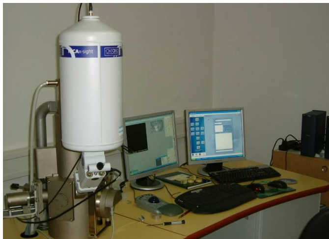
Slika 51. Skenirajući elektronski mikroskop Tescan Vega 5136 MM i EDX analizator Oxford Instruments
