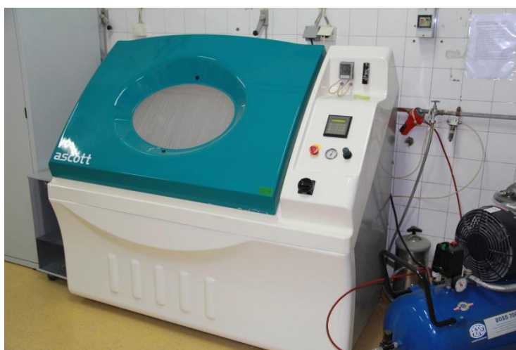
Slika 45. Slana komora Ascott S450
