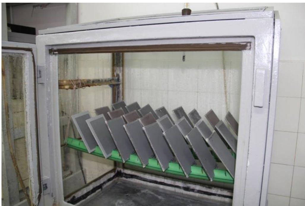
Slika 44. Uzorci u vlažnoj komori na početku ispitivanja
