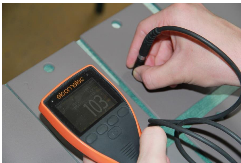
Slika 43. Mjerenje debljine suhog filma premaza uređajem Elcometer 456
