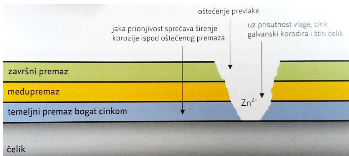
Slika 12. Galvanski učinak zaštite premazima [5]
