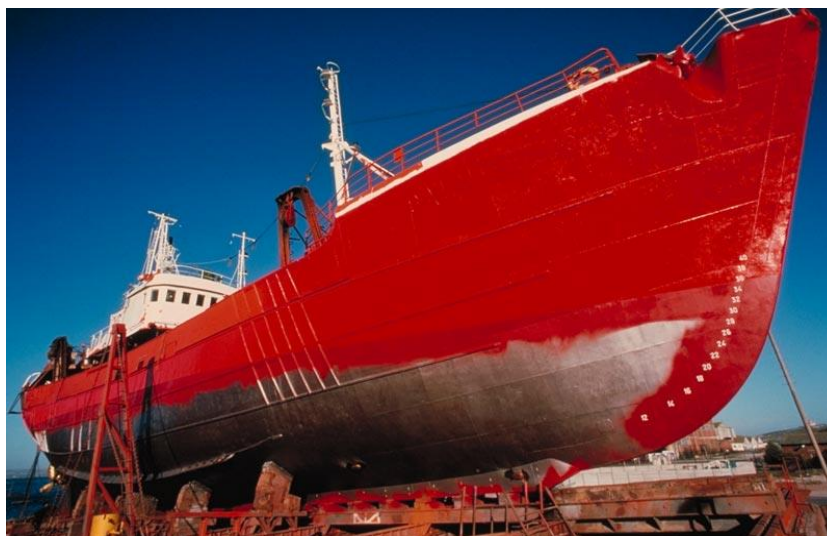
Slika 3. Primjena zaštitnih prevlaka za brodove [8]
