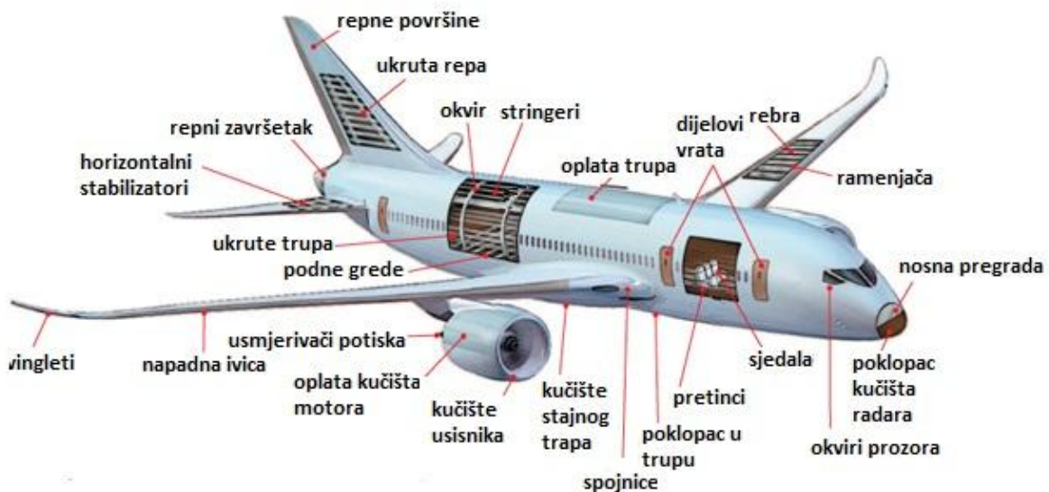
Slika 13. Primjena Al-legura na velikom putničkom zrakoplovu
