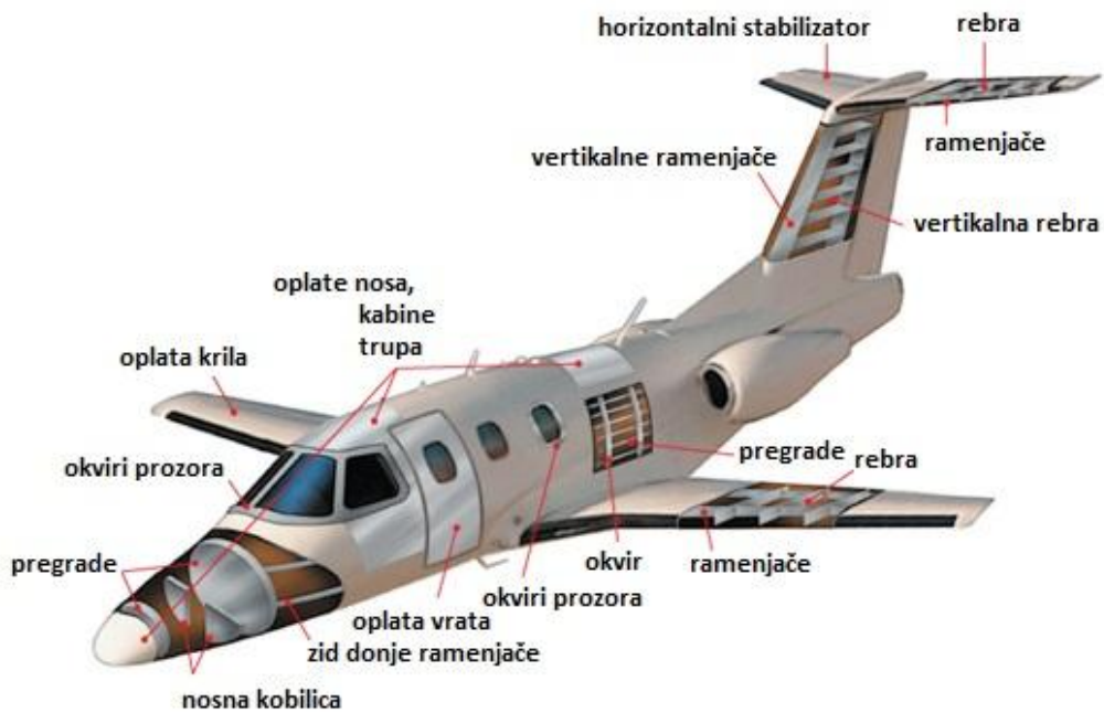
Slika 12. Primjena Al-legura na malom mlažnjaku
