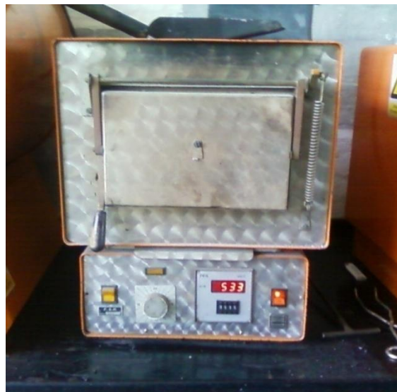
Slika 20. Komorna elektro peč
