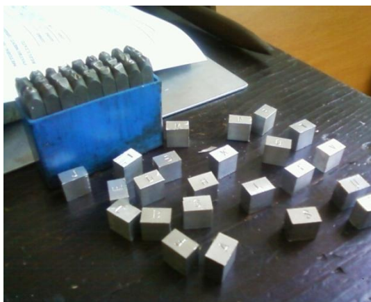
Slika 15. Izrezani i označeni uzorci
