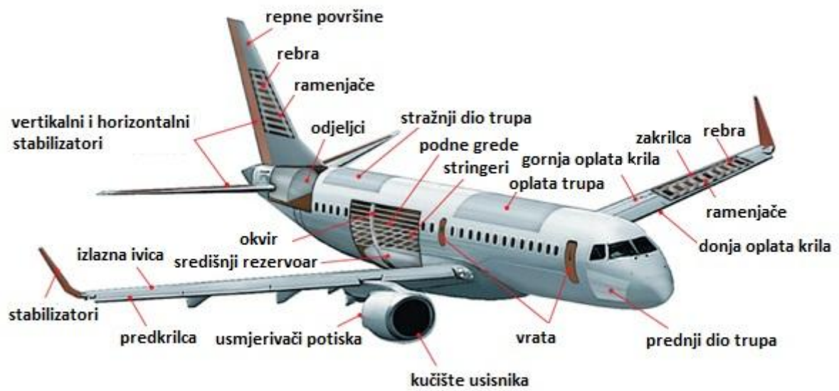
Slika 14. Primjena Al-legura kod zrakoplova za regionalne letove
