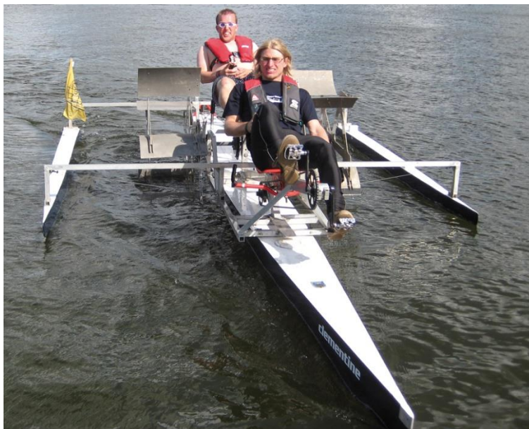
Slika 14. Trimaranska forma, brodocikl „Clementine“ [7]
