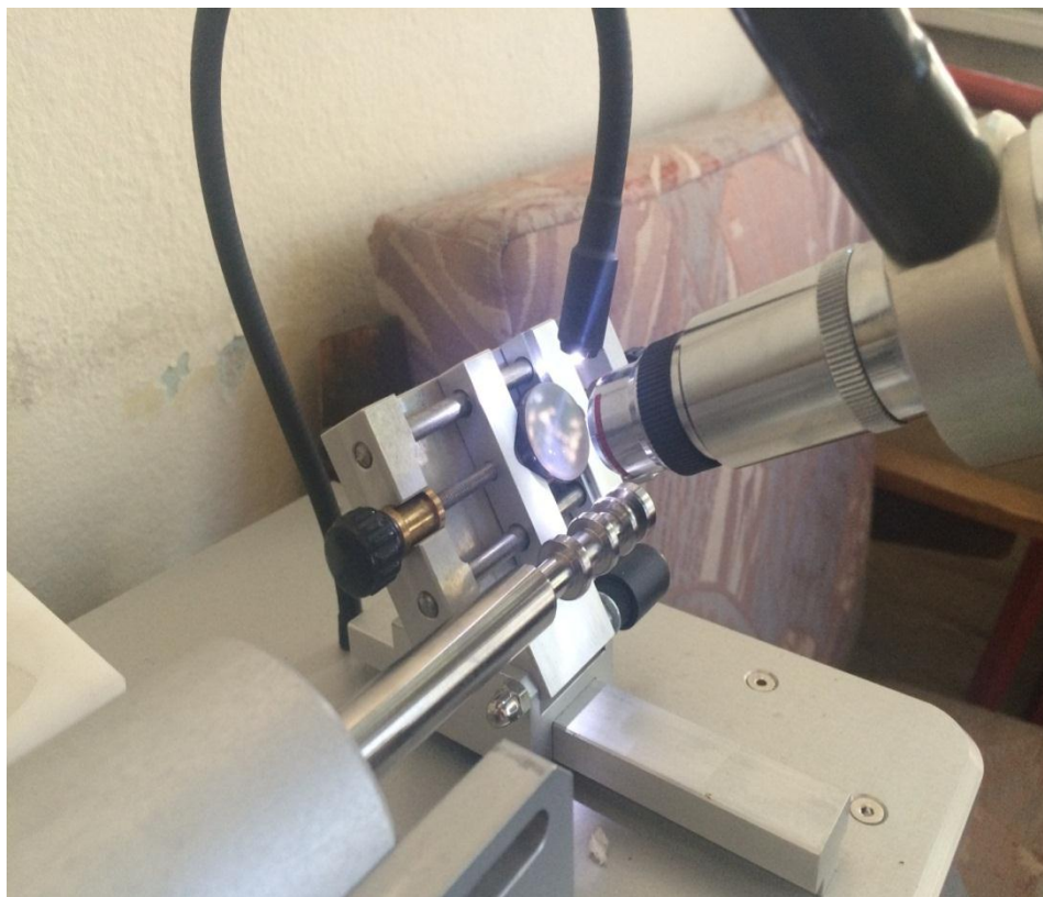
Slika 16: Mjerenje debljine prevlake
