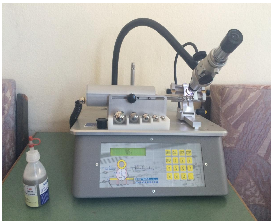
Slika 15: Kalotester za mjerenje debljine slojeva prevlake
