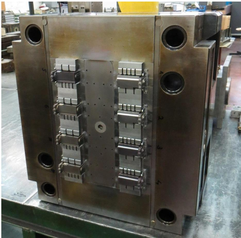
Slika 11: Kalup za injekcijsko prešanje polimernih komada
