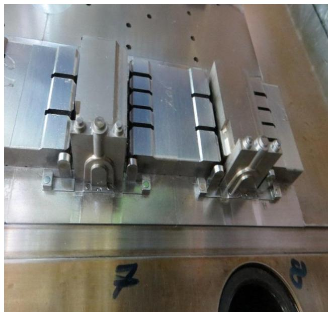
Slika 12: Umetak kalupa
