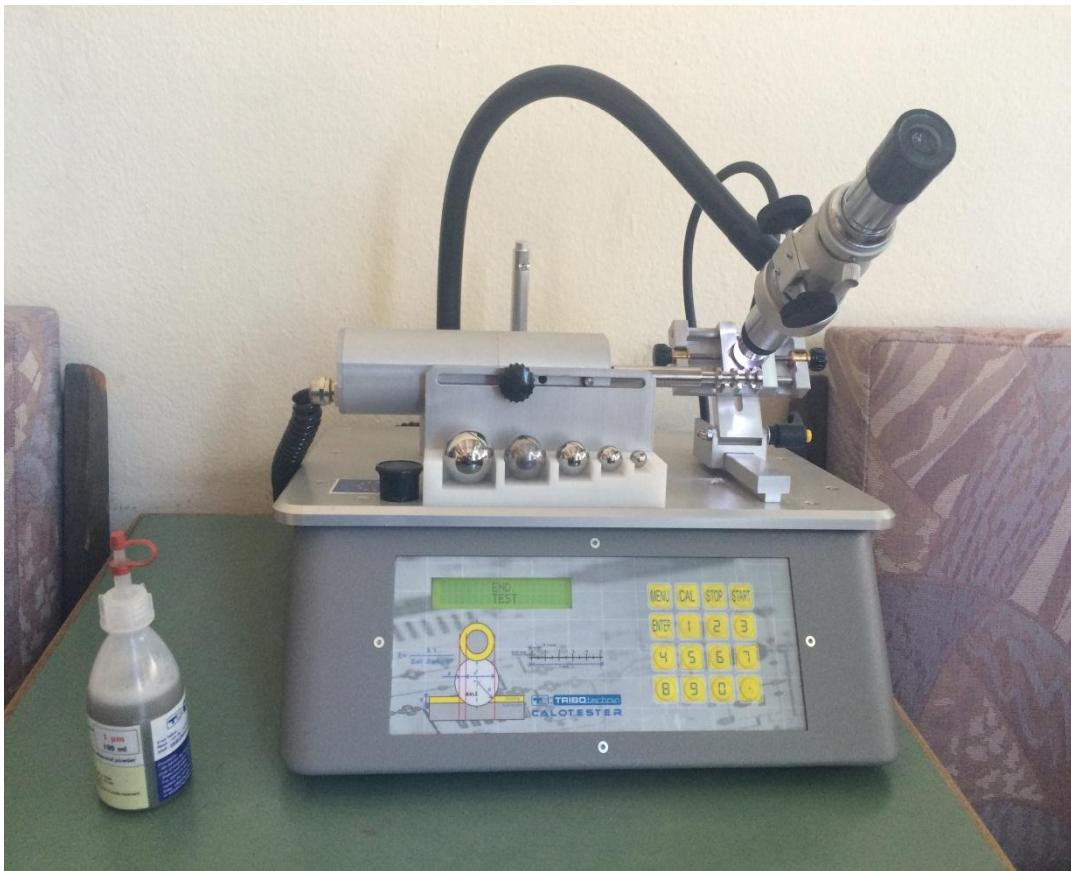
Slika 15: Kalotester za mjerjenje debljine slojeva prevlake
