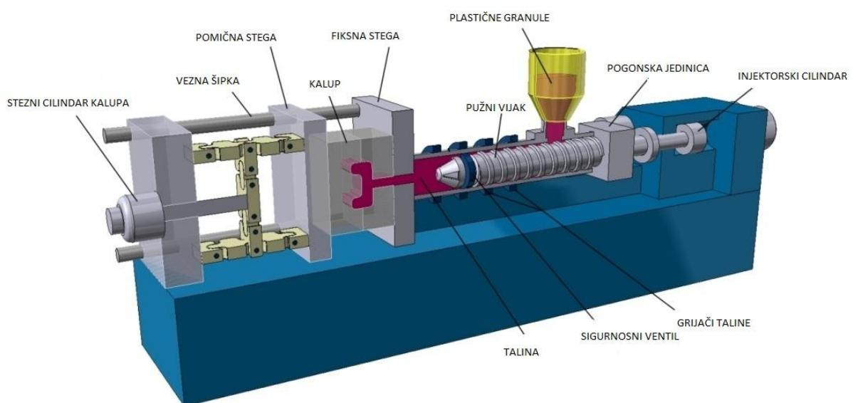
Slika 1: Shematski prikaz uređaja za injekcijsko prešanje polimera [17]
