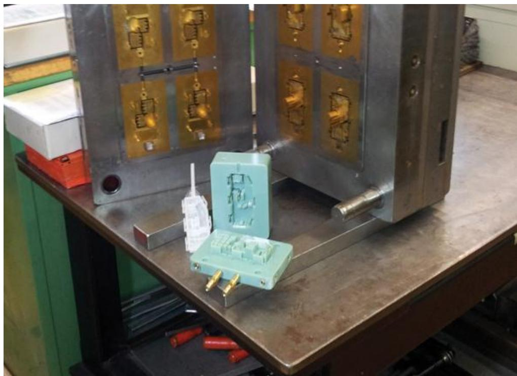
Slika 2: Primjer bakrenog kalupa za injekcijsko prešanje plastomera [18]
