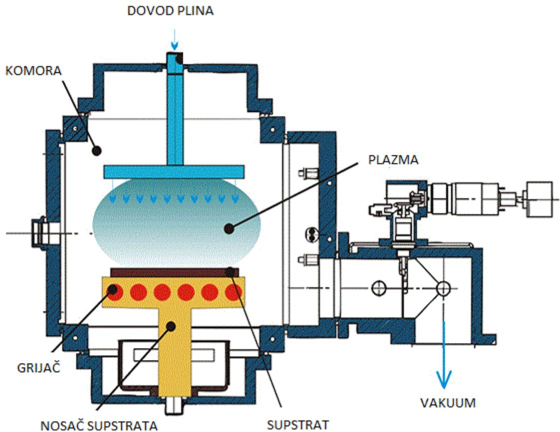
Slika 4: Prikaz provođenja CVD postupka [19]
