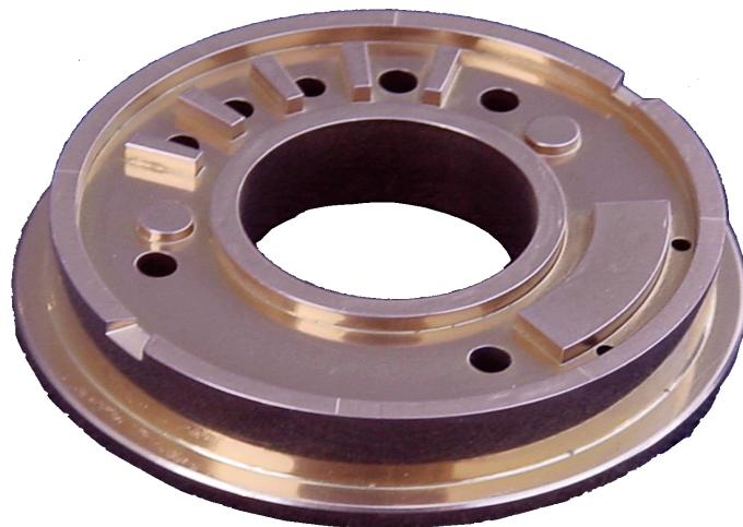
Slika 9: Prikaz strojnog dijela prevučenog TiCN prevlakom [22]
