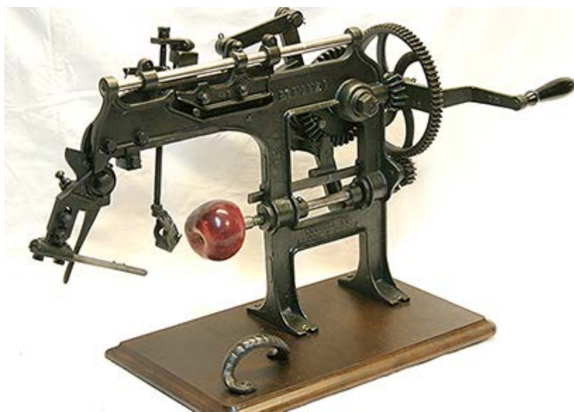
Slika 1. Uređaj za guljenje jabuka, Goodell Company, 1880.god.
