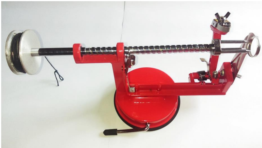
Slika 15. Uređaj sa užnicom umjesto ručice
