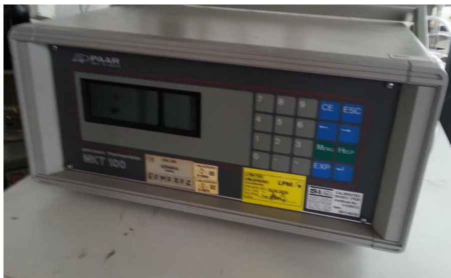
Slika 8. Otpornički most MKT 100
