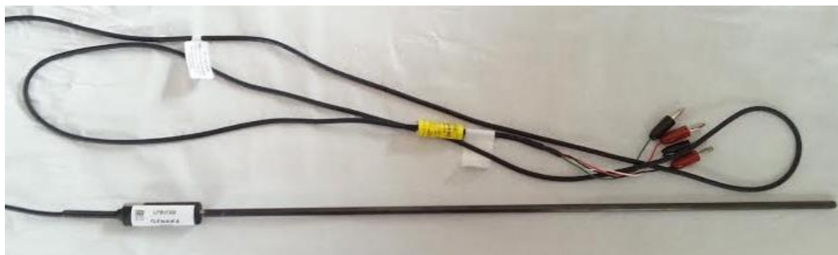
Slika 7. Termometri korišteni za mjerenje temperature kupke
