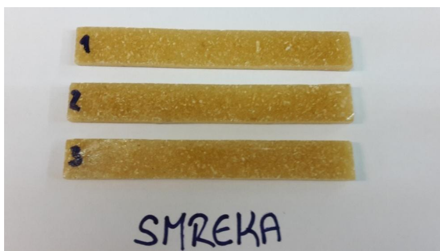
Slika 16. Kompozit sa sitnim česticama smreke
