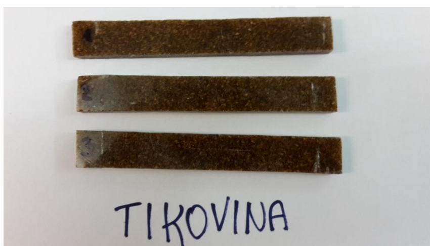
Slika 15. Kompozit sa sitnim česticama tikovine
