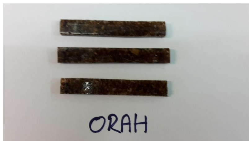
Slika 22. Kompozit s krupnim česticama oraha
