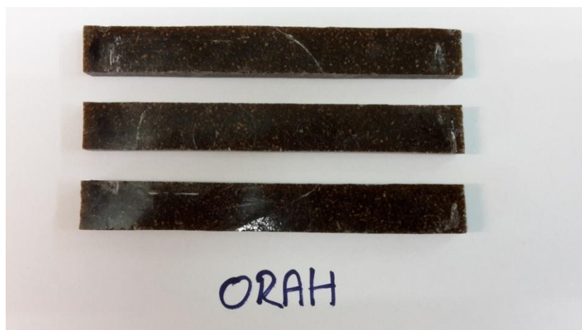
Slika 17. Kompozit s sitnim česticama oraha
