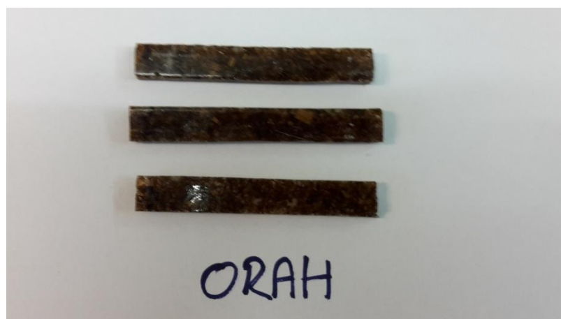
Slika 22. Kompozit s krupnim česticama oraha
