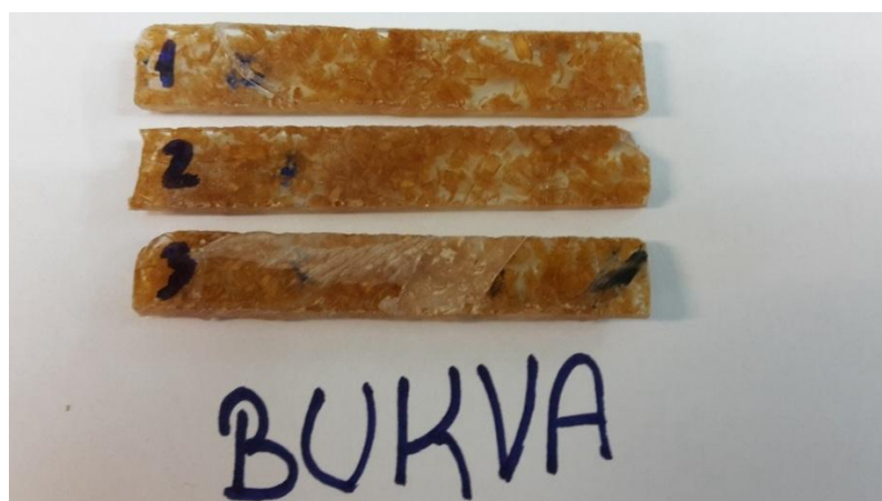
Slika 19. Kompozit s krupnim česticama bukve
