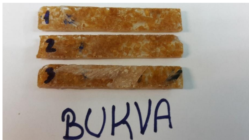
Slika 19. Kompozit s krupnim česticama bukve
