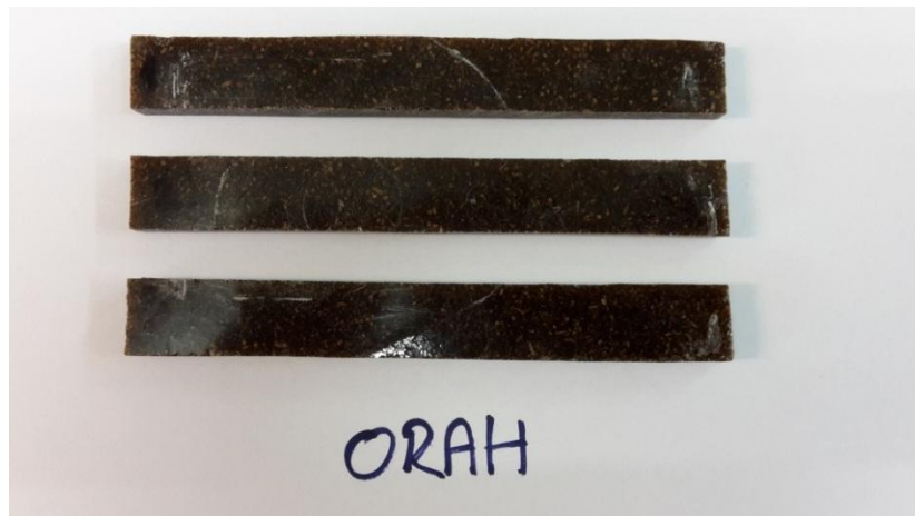
Slika 17. Kompozit s sitnim česticama oraha
