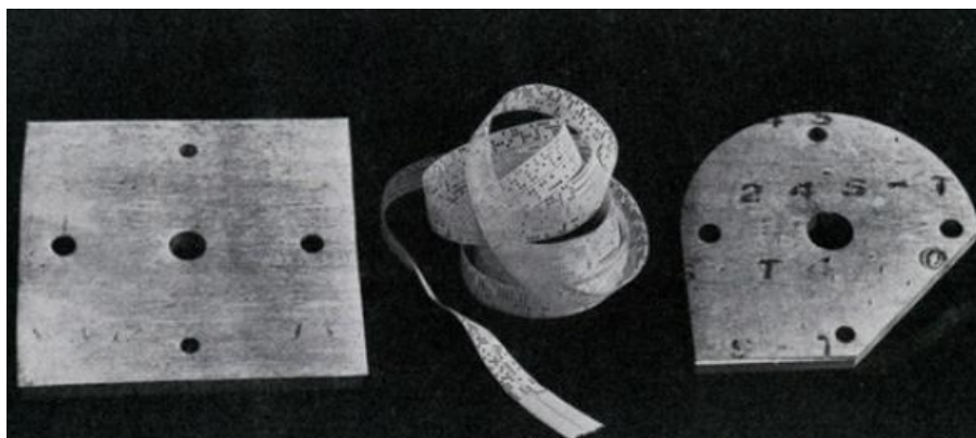
Slika 4. Pripremak, bušna vrpca i obradak prve obrade na Cincinnati Hydrotel glodalici
