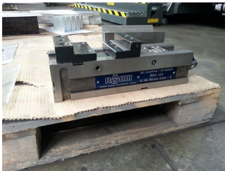
Slika 24. Stezna naprava trećeg stezanja - škripac
