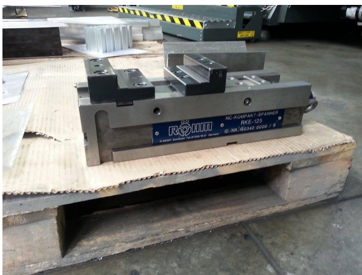
Slika 24. Stezna naprava trećeg stezanja - škripac
