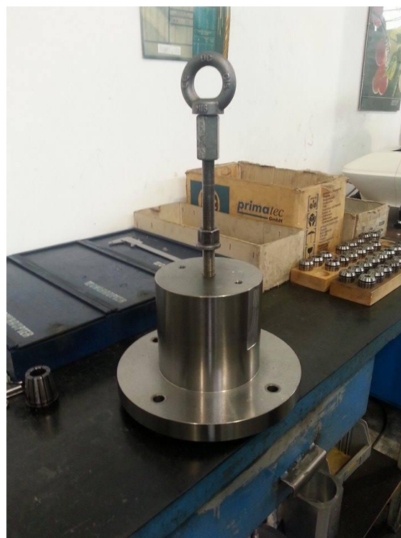
Slika 18. Stezna naprava drugog stezanja – „gljiva“
