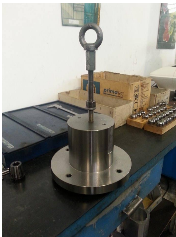
Slika 18. Stezna naprava drugog stezanja – „gljiva“
