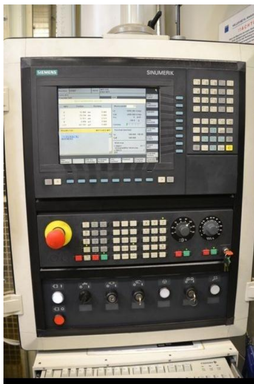
Slika 11. Upravljačko računalo na stroju „HELLER MC 16“
