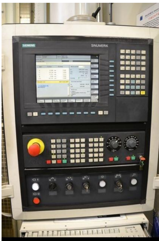
Slika 11. Upravljačko računalo na stroju „HELLER MC 16“
