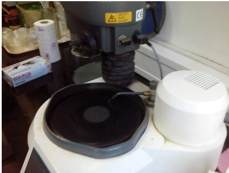
Slika 35. Vodeno hlađenje rezne ploče
