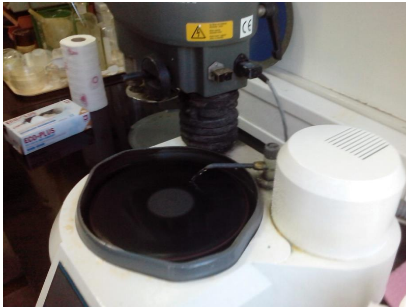
Slika 35. Vodeno hlađenje rezne ploče
