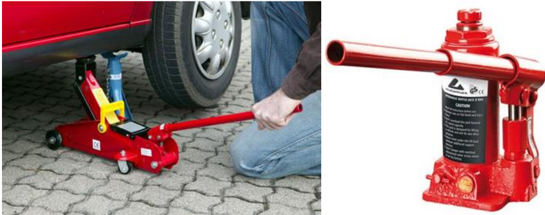
Slika 1.3: Automobilska hidraulička dizalica (lijevo), Industrijska hidraulička dizalica (desno)
