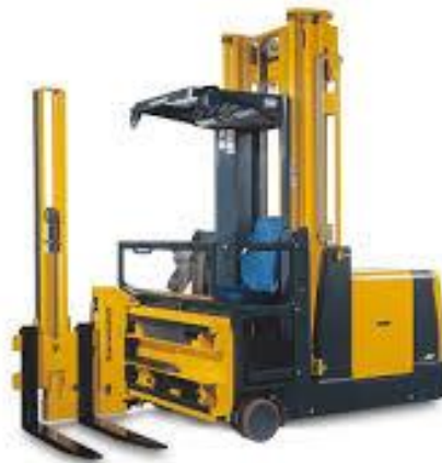
Slika 17. Prikaz predloženog viličara sa zakretnim vilicama
