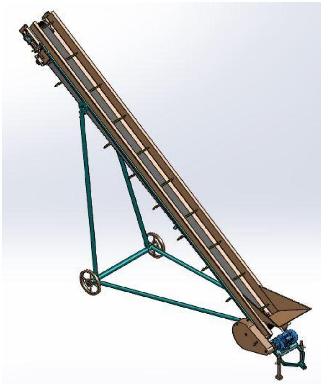
Slika 28. Slika konačnog modela u izometriji
