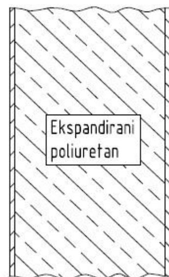
Slika 9. Slojevi stijenke zida
