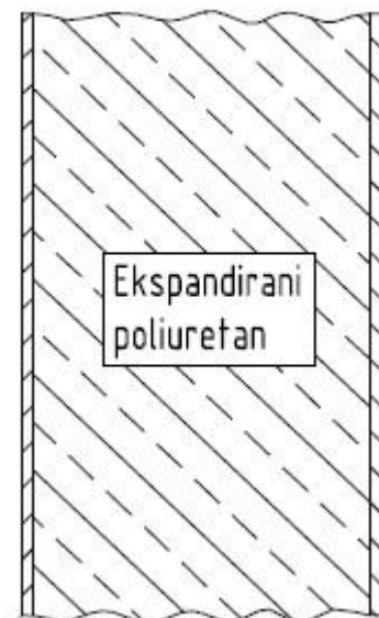
Slika 13. Slojevi stijenke zida
