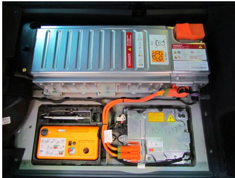
Slika 2.6 Smještaj baterijskog paketa u prtljažniku vozila [3]
