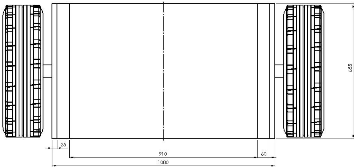
Slika 3.5 Izmjera raspoloživog prostora za ugradnju električnog pogona-tlocrt
