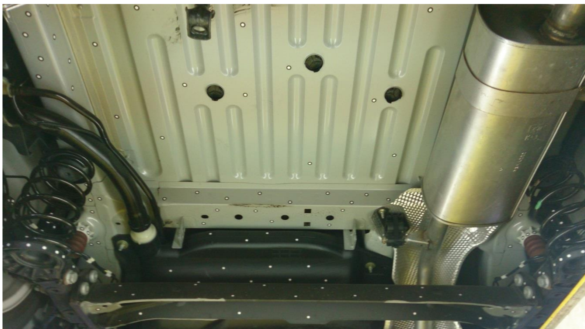
Slika 3.3 Prostor za ugradnju električnog pogona
