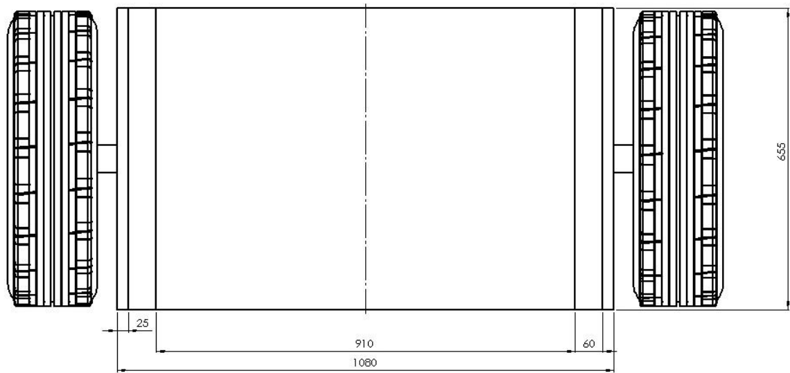
Slika 3.5 Izmjera raspoloživog prostora za ugradnju električnog pogona-tlocrt
